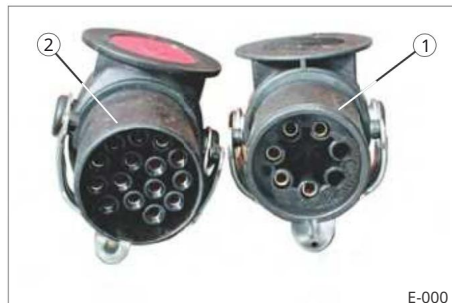
7. ábra Dugaszoló csatlakozások, standard 24 V 1 db 7 tűs EBS/ABS csatlakozó (ISO 7638) 2 db 15 tűs elektromos csatlakozó (ISO 12098)
