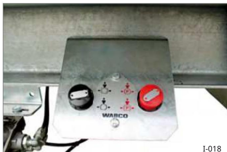
18. ábra Rugós hengerrel ellátott légfogós rögzítő
