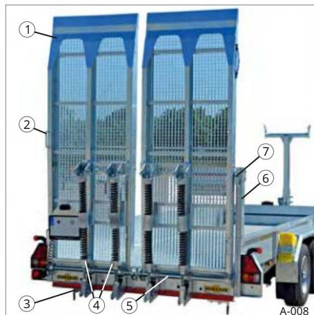
16. ábra HS széles acél rámpákkal, rugós emelőszerkezettel
