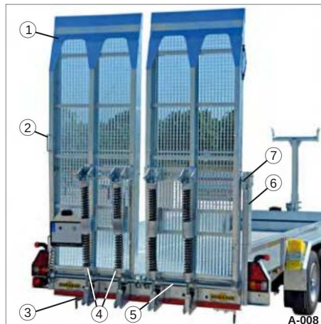
Kuva 16 HS leveillä teräsrampeilla ja jousimekanismeilla
