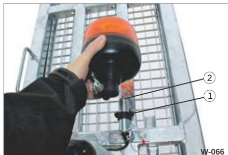
Kuva 66 Pyörivän majakan irrottaminen
