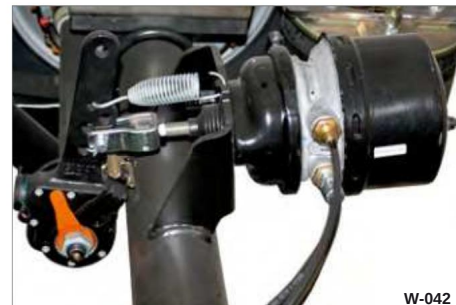
Kuva 42 Jousen jännityksen vapauttaminen
