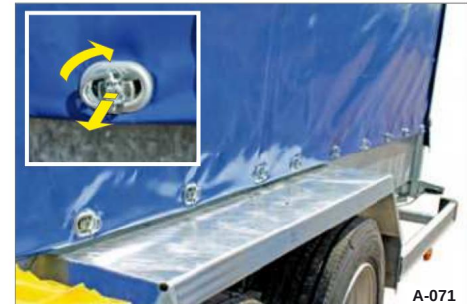
Kuva 75 Pressun lukituksen avaaminen sivulta
