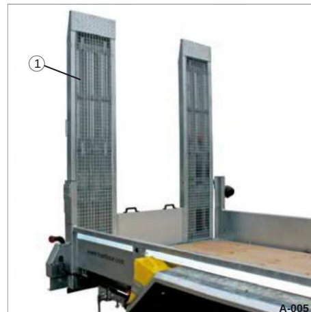
Kuva 14 HS teräsrampeilla ja kaasujousituella
