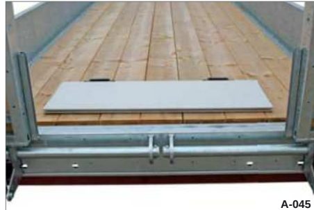
Kuva 47 Pistokeliitännällä varustettu sivuseinä irrotettu
