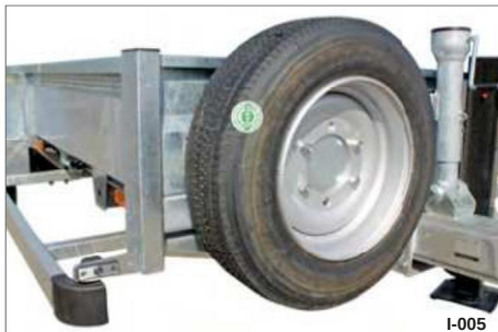
Kuva 5 Varapyörän pidike väliseinässä
