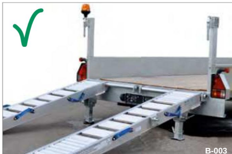
Kuva 3. Taittavat tuet alas käännettyinä
