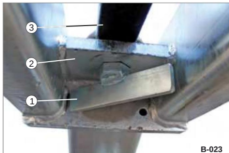
Kuva 22 Vetosilmukka D40, saranoitu ylhäältä
