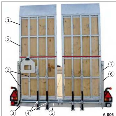
Kuva 15 HS leveillä teräsrampeilla ja kaasujousituella
