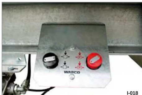
Kuva 18 Jousikuormitteisella sylinterillä varustettu paineilmakäyttöinen seisontajarru
