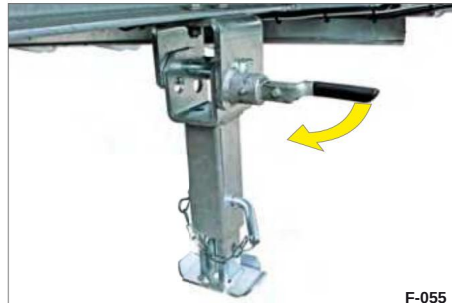
Kuva 39 Taittuva tukijalka avattuna
