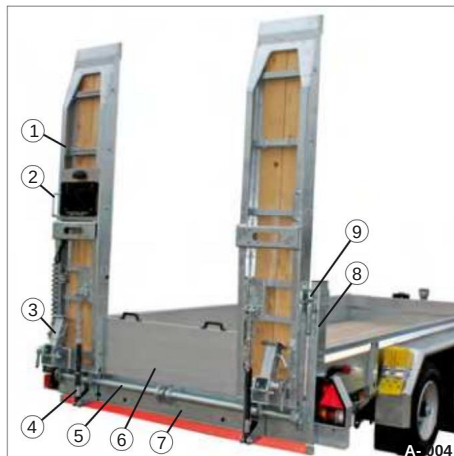
Kuva 13 HS teräsrampeilla ja kaasujousituella
