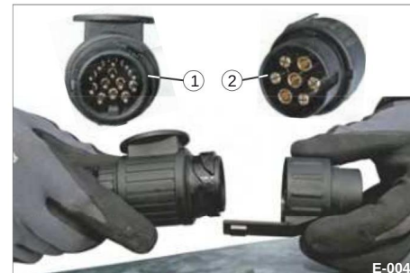
Kuva 5 Sovitin 7-nastaisesta 13-nastaiseen
