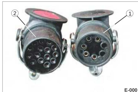
Fig. 7 Stikforbindelser, standard 24 V 1 7-benet EBS/ABS-stik (ISO 7638) 2 15-bens elektriske stik (ISO 12098)
