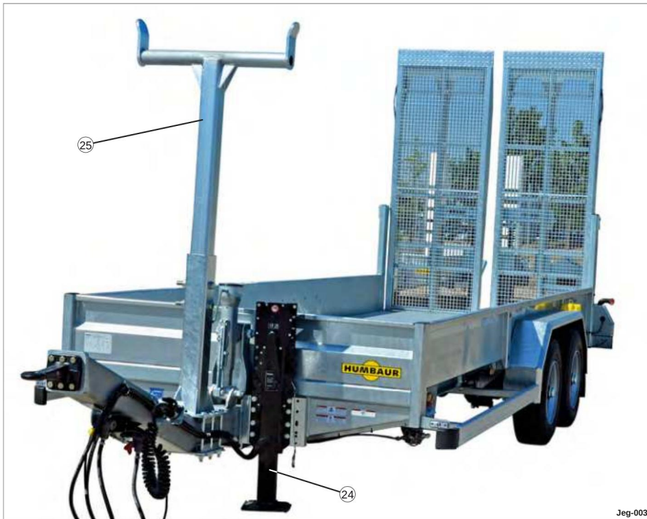
Fig. 3 HS til transport af fræsebånd
