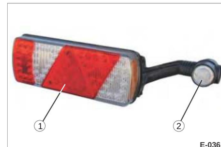
Fig. 25 Multifunktionslampe "LED" 24 V
