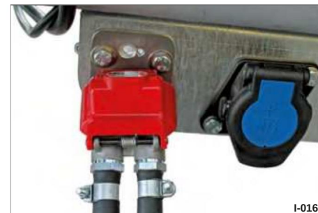
Fig. 16 for trykluft: forsyning / bremse
