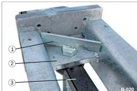
Fig. 19 Trækøje D50 hængslet i bunden
