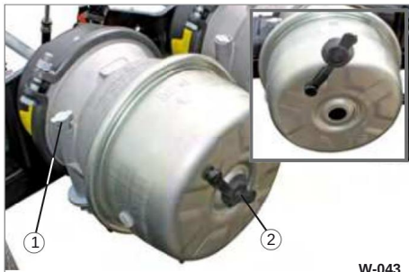
Fig. 43 Fjederbelastet membrancyliner 1 udløsserskrue 2 hætter (hul)
