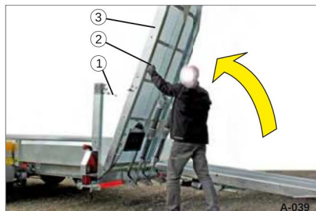
Fig. 41 Løftning af adgangsrampen i ét stykke
