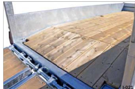
Fig. 21 Træplanker (grantræ 40 mm)
