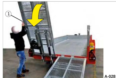
Fig. 30 Sænkning af adgangsrampen
