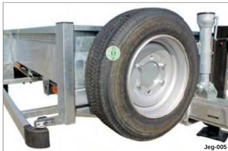
Fig. 5 Reservehjulsholder på skillevæggen
