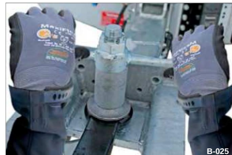
Fig. 24 Spændeøjer D40 fastgjort
