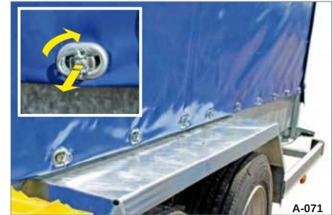
Fig. 75 Oplåsning af presenningsdelen på siden
