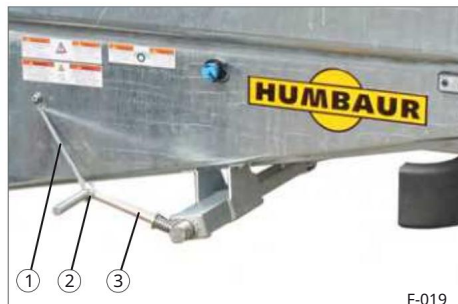
Obr. 44 Parkovací brzda vřetena zajišťuje ná v jí zdní poloze
