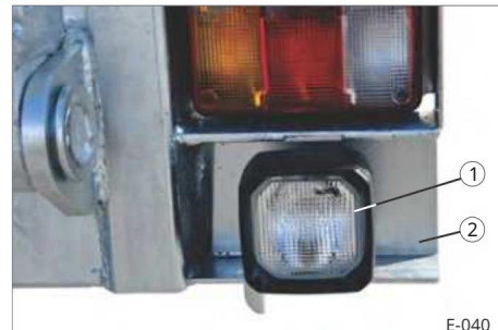
Obr. 32 Pracovní světlá na ochraně proti podjetí
