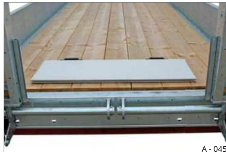
Obr. 47 Odstranění zásuvnéboční stěny
