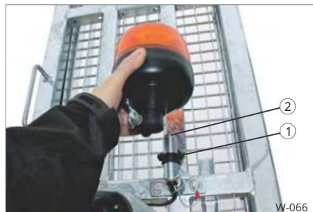
Obr. 66 Demontáž rotační ho majáku
