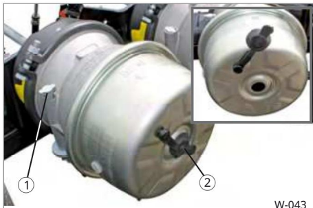
Obr. 43 Pružinový membránový válec 1 uvolňovací šroub 2 víčko (otvor)
