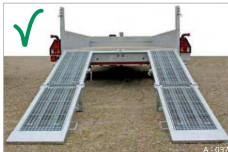
Obr. 39 Spuštěné nakládací rampy
