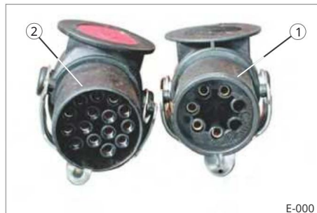
Obr. 7 Zásuvkové připojení, standardní 24 V 1 7pinový konektor EBS/ABS (ISO 7638) 2 15kolí kové elektrické konektory (ISO 12098)
