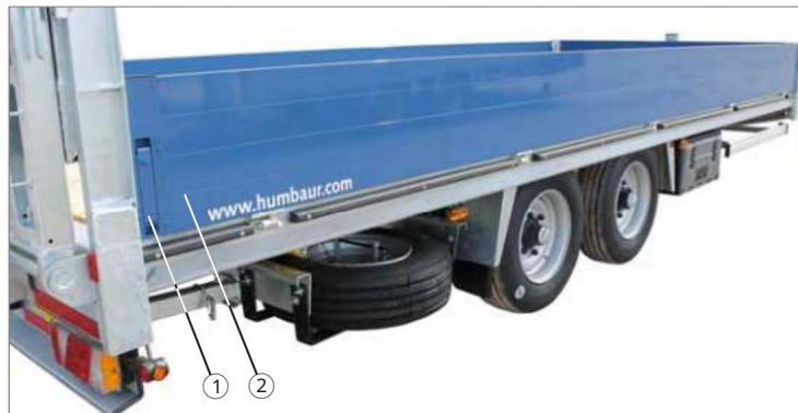
Slika 113 Stranske stene - Izvedba: Aluminij
