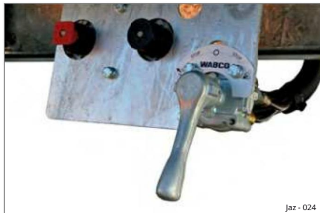
Slika 25 Kontrolna točka na zadnji strani za nastavitev višine podvozja
