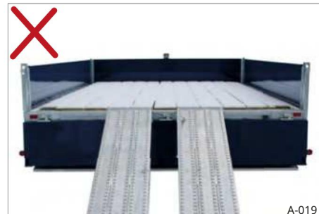
Slika 24 Nakladalne rampe - preveč navznoter
