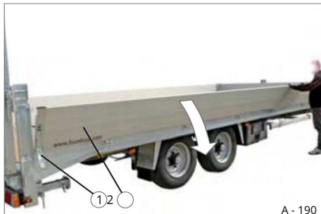
Slika 120 Stranska stena odklenjena 1 stranska stenska ključavnica, ODPPTO 2 Stranska stena, odklenjena
