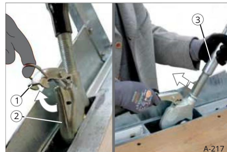
Slika 56 Sprostitev spodnje varnostne palice 1 Zaklep 2 Kavelj 3 Varnostna palica
