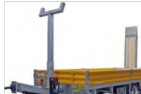
Slika 22 name šena na cevni ojnici
