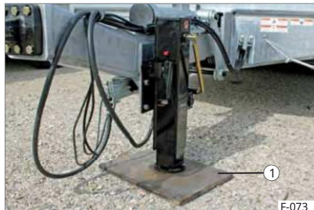
Slika 46 Stabilizirana oporna noga
