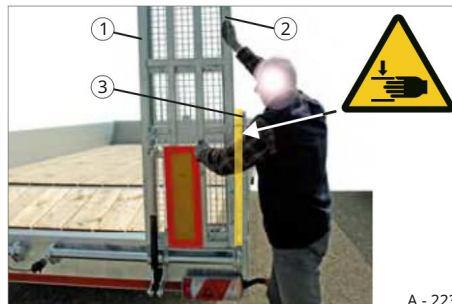
Slika 75 Premikanje dostopne rampe
