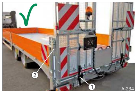
Slika 111 Dostopne rampe, zavarovane
