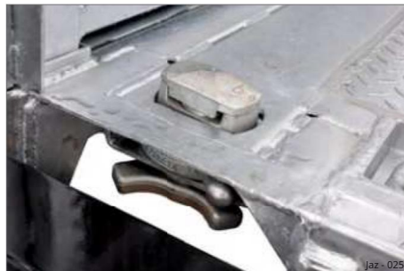
Slika 26 Zaklepanje posode "Twist-Lock"
