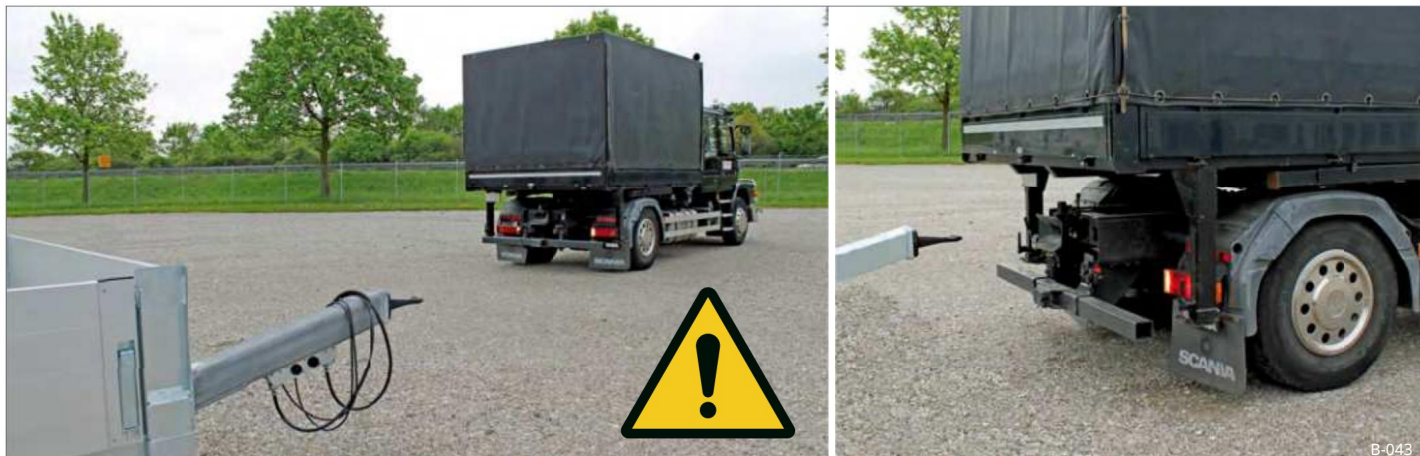
Slika 33 Priklopna naprava za prikolico
