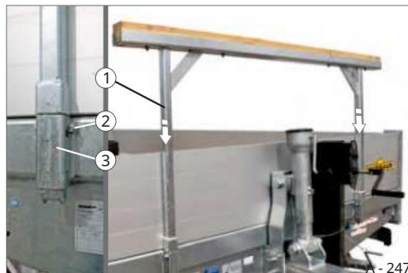
Slika 177 Nosilec, pritrjen na šasijo
