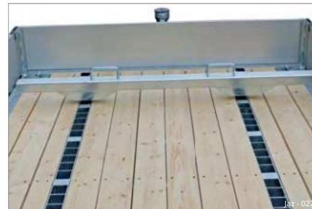
Slika 28 Varnostna ograja kot zaustavitev kolesa
