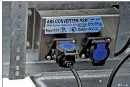
Slika 32 Pretvornik napetosti (12 V - 24 V)
