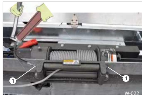
Slika 26 Primer: Mazanje valjev z navodili
