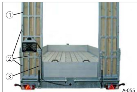
Slika 89 Enodelne dostopne rampe
