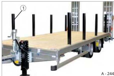
Slika 168 Primer: Stebri brez stranskih sten 1 steber, stranski
