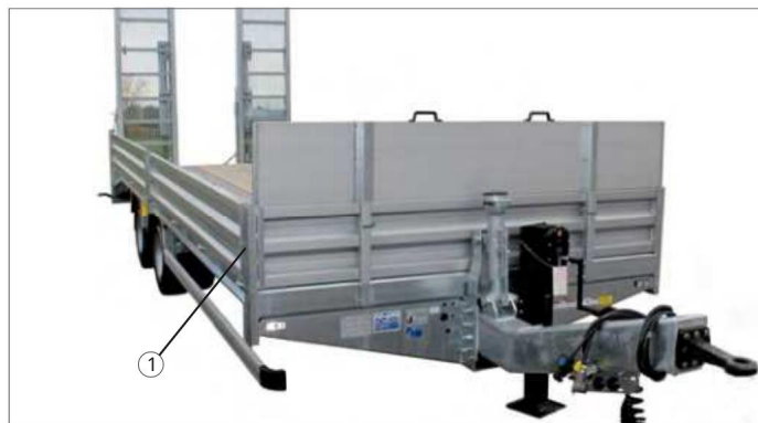
Slika 114 Stranske stene - Izvedba: Jeklo
