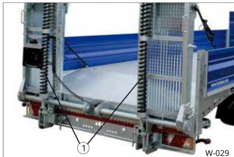
Slika 33 Vzmetni dvigalni mehanizem za dostopne rampe
