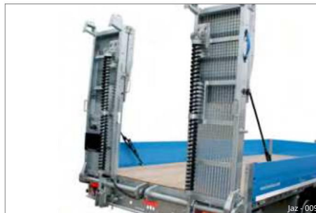
Slika 8 1/3 delitev, z vzmetnim dvžnim mehanizmom
