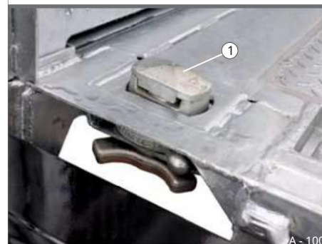
Slika 153 Zaklepanje kontejnerja 1 zaklepna točka "Twist-Lock"
