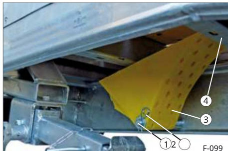
Sl. 92 Zagozda za kolo parkirana pod šasijo zadaj
