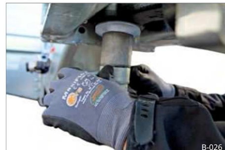
Slika 23 Napenjalne ušesce D50 pritrjene
