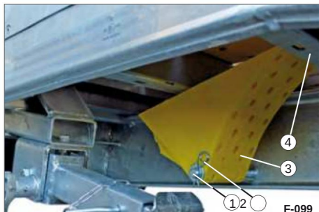
Fig. 92 Hjulkloss parkert under chassiset bak
