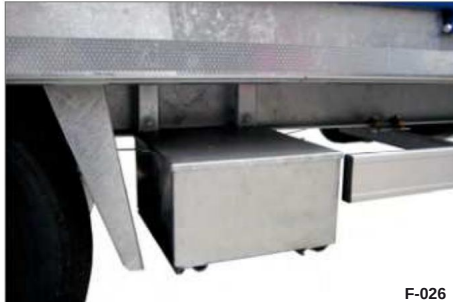
Fig. 43 Batteriboks på siden under chassiset
