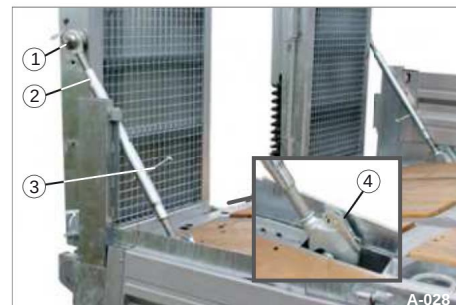
Fig. 39 Lasteramper med sikkerhetsstang
