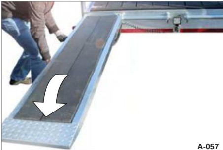
Figur 91 Senking av tilgangsrampen
