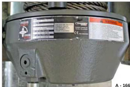
Fig. 214 Eksempel: Typeskilt på kabelvinsjen
