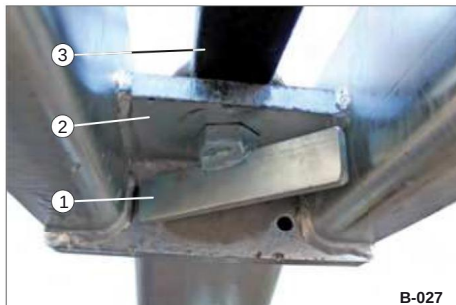
Fig. 24 Trekkøye D40 hengslet øverst
