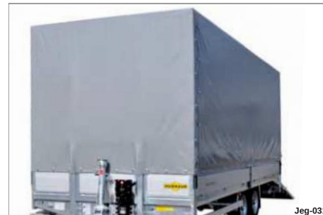
Fig. 29 Bauspant med heldekkende presenning
