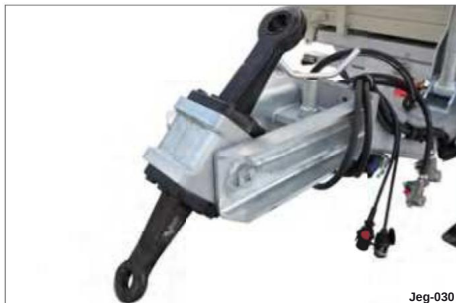
Fig. 30 Svingbart malje D 40 mm / 50 mm
