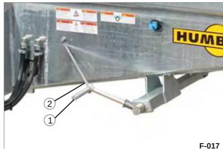
Fig. 19 Spindelparkeringsbrems sikret 1 sveiv 2 sikkerhetstau med kroker
