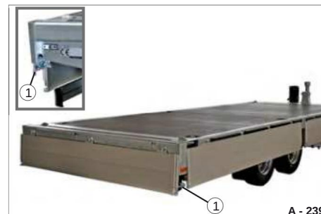
Fig. 125 Sidevegger nedbrettet rundt
