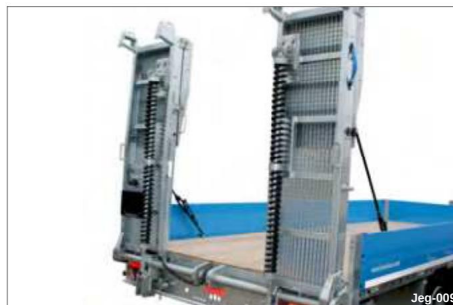
Fig. 8 1/3-delt deling, med fjærløftemekanisme
