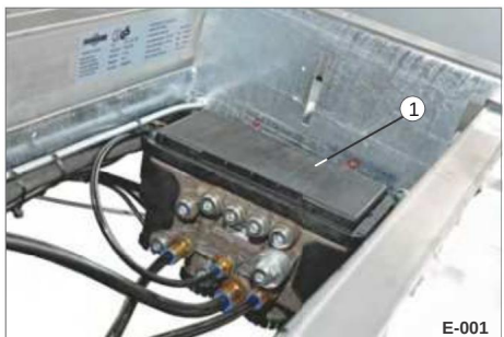
Fig. 1 Bremsemodul, programmerbar 1 Bremsemodul (EBS-modulator)
