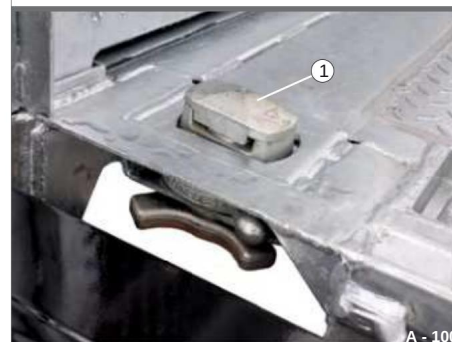
Figur 153 Låsing av container 1 låsepunkt "Twist-Lock"
