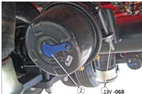
Fig. 53 Fjærbelastet membransylinder 1 utløsserskrue 2 hetter (hull)
