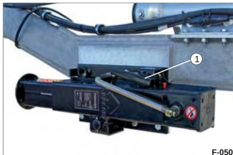
Fig. 52 Svingbar støtte / kjørestilling
