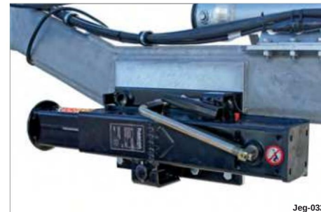
Fig. 34 montert på rørtrekkestang
