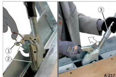
Fig. 56 Løsne den nedre sikkerhetsbøylen 1 Lås 2 Krok
