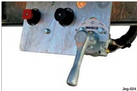
Fig. 25 Kontrollpunkt bak, for høydejustering av chassiset
