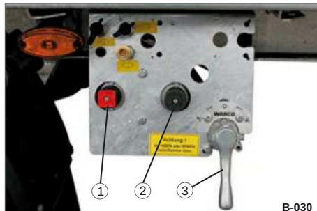
Figur 35 Aktivering av parkeringsbremsen (HBTZ 19 t)
