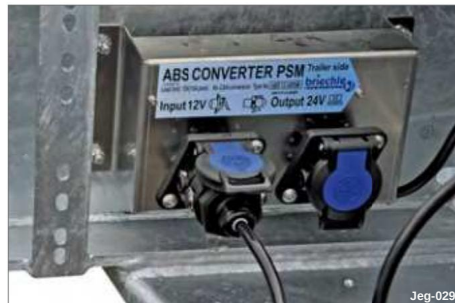
Figur 32 Spenningsomformer (12 V - 24 V)
