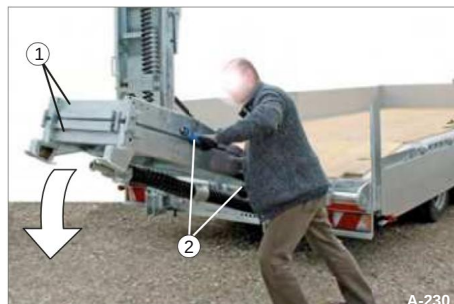
Figur 94 Senking av tilgangsrampen
