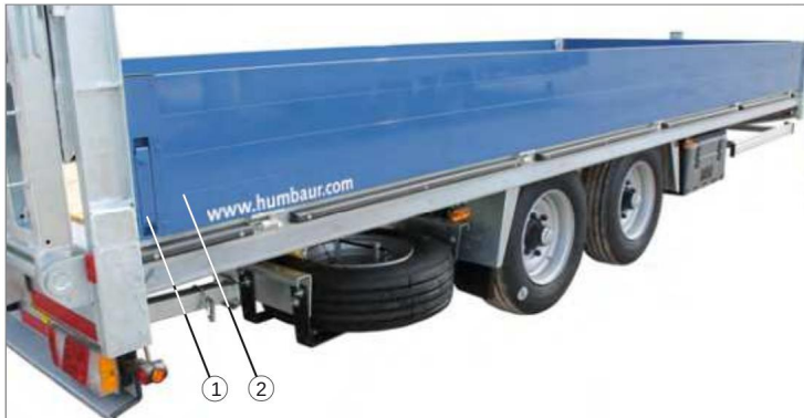
Fig. 113 Sidevegger - Utførelse: Aluminium
