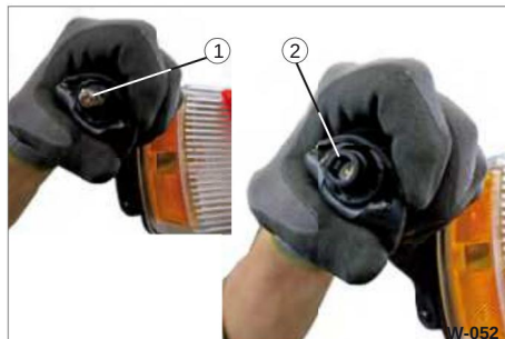
Figur 60 Bytte av lampe
