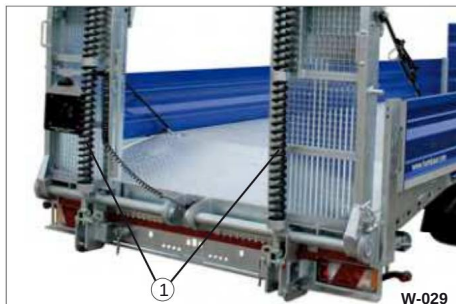
Fig. 33 Fjærløftemekanisme for adkomstramper 1 fjærer
