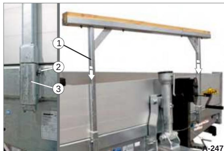
Fig. 177 Støttebrakett festet til chassiset
