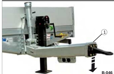
Fig. 41 Høydejustering av trekkstangen
