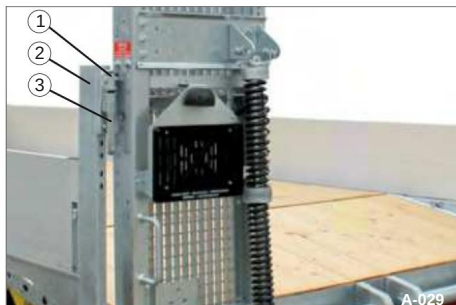
Fig. 40 Ramper med sikkerhetslås
