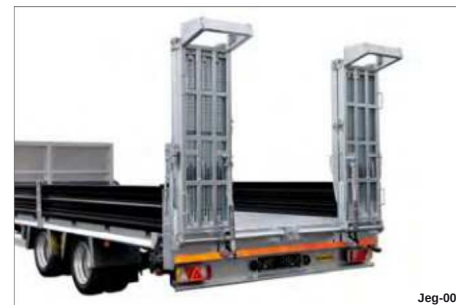
Fig. 10 1/2 stigning, med gassfjærer
