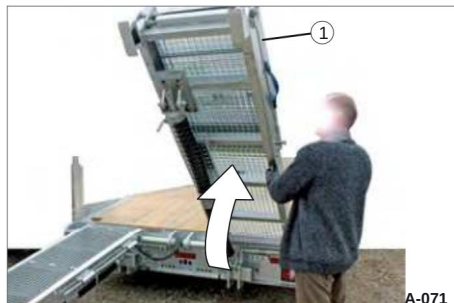
Fig. 108 Løfte opp adkomstrampen i to deler
