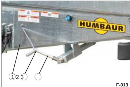
Fig. 15 Spindelparkeringsbrems festet i kjørestilling
