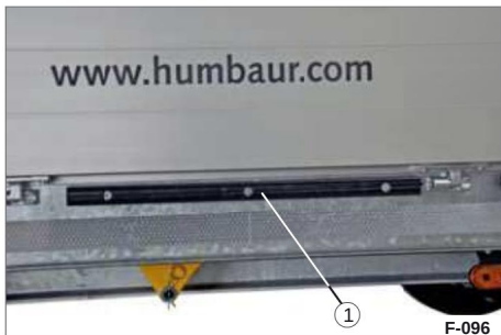
Figur 85 Sidekollisjonsbeskyttelse 1 krasjbøyle, delt
