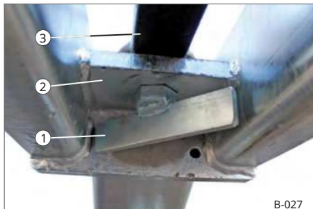
24 pav. Viršuje užlenkta traukimo kilpa D40
