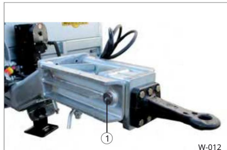
15 pav. Sukamosios ašies tepimas 1 tepalo į mova (su apsauginiu dangteliu)
