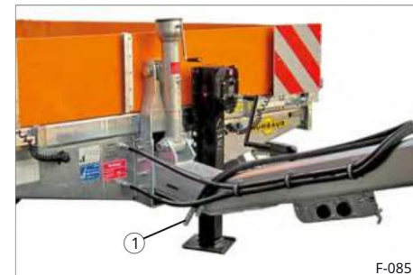
36 pav. Hidraulinės linijos pastatymas
