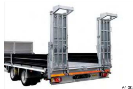
10 pav. 1/2 žingsnio, su dujinėmis spyruoklėmis
