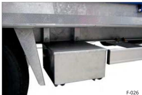
43 pav. Akumuliatoriaus dėžutė šone po važiuokle
