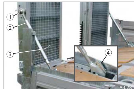
39 pav. Pakrovimo rampos su apsauginiu strypu
