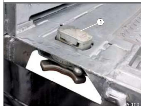
153 pav. Konteinerio užrakinimas 1 užrakinimo taškas „Twist-Lock“
