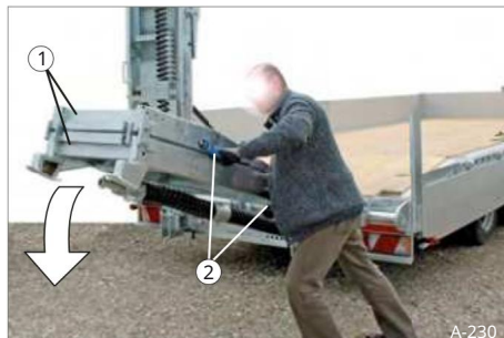
94 pav. Įvažiavimo rampos nuleidimas
