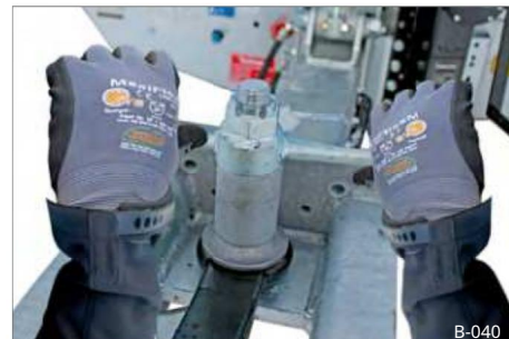
26 pav. Įtempimo kilpos D40 pritvirtintos
