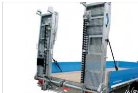
8 pav. 1/3 padalijimo, su spyruokliniu kėlimo mechanizmu
