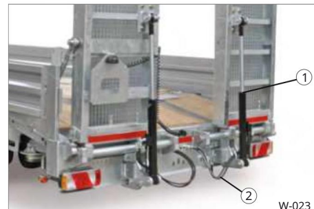
27 pav. Cilindrų tikrinimas / techninė priežiūra
