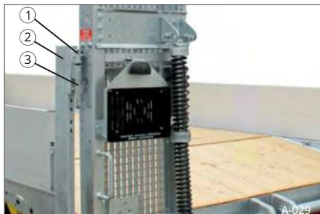
40 pav. Rampos su apsauginiu užraktu 1 Apsauginis užraktas 2 Kampinis stulpas 3 Fiksavimo rankena
