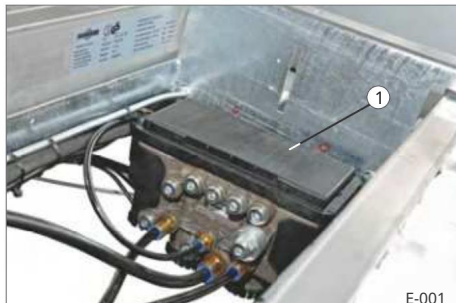
1 pav. Stabdžių modulis, programuojamas 1 Stabdžių modulis (EBS moduliatorius)
