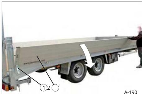
120 pav. Šoninė sienelė atrakinta 1 šoninės sienos užraktai, ATIDARYTA 2 Šoninė sienelė, neužrakinta
