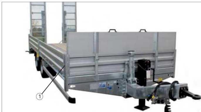
114 pav. Šoninės sienelės – konstrukcija: plienas
