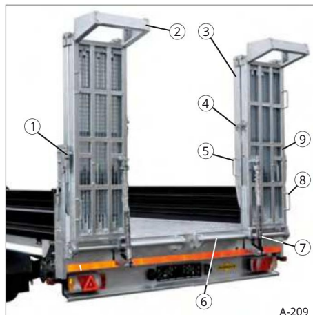
35 pav. HBT BS 13 t pakrovimo rampos su dujinėmis spyruoklėmis
