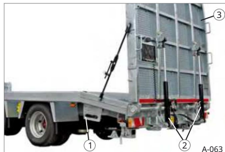
101 pav. Hidraulinė rampos sienelė
