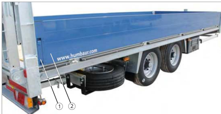
113 pav. Šoninės sienelės – konstrukcija: aliuminis
