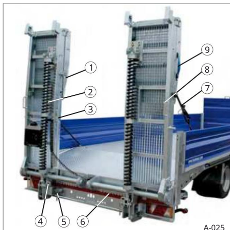
34 pav. HBT BS 13 t pandusai su spyruokliniu kėlimo mechanizmu
