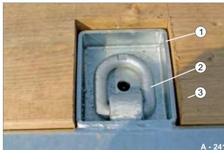
Fig. 145 Anello di ancoraggio ripiegato
