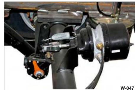
Fig. 52 Rilassamento della molla
