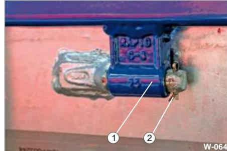
Fig. 22 Cerniera della parete laterale, fissata
