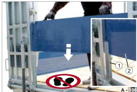
Fig. 195 Inserimento della parete laterale ad innesto
