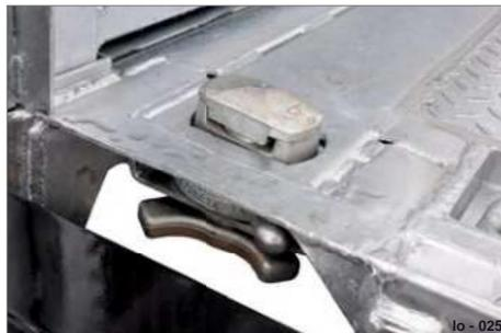
Fig. 26 Bloccaggio del contenitore "Twist-Lock"
