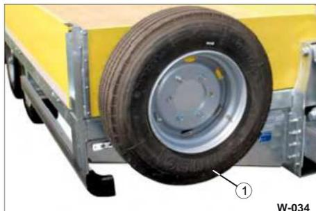
Fig. 39 Ruota di scorta sul pannello anteriore
