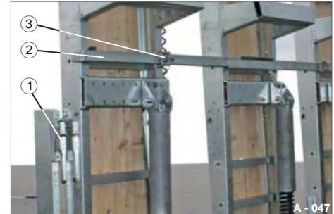
**Fig. 42** Tre rampe di accesso con blocco di sicurezza e aste 1 maniglia di bloccaggio 2 picchetti d'angolo 3 Sicurezza 4 Querstange 5 viti di bloccaggio
