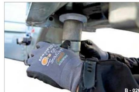
Fig. 23 Occhielli di tensione D50 fissati
