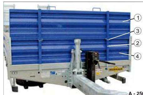
Fig. 185 Fissaggio della parete laterale in acciaio
