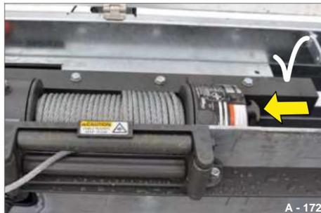
Fig. 220 Leva frizione innestata
