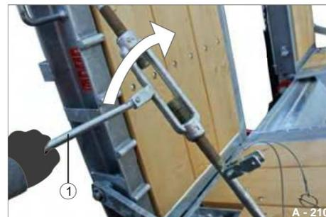
Fig. 45 Rilasciare il morsetto di sicurezza
