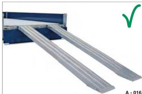
Fig. 20 Rampe di carico - posizione media
