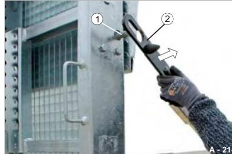
**Fig. 52 Rimuovere il morsetto di sicurezza
