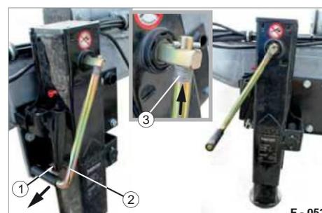
Figura 54 Schwenkst<sub>t</sub>ze - Posizione di St<sub>t</sub>z
