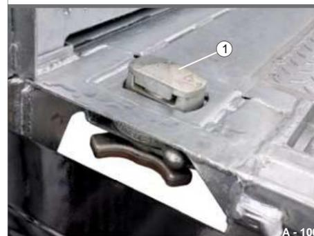
Fig. 153 Bloccaggio del contenitore
