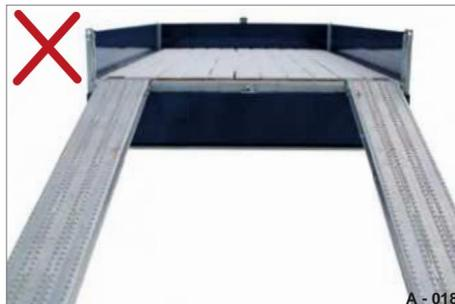
Fig. 23 Rampe di carico - troppo avanzate
