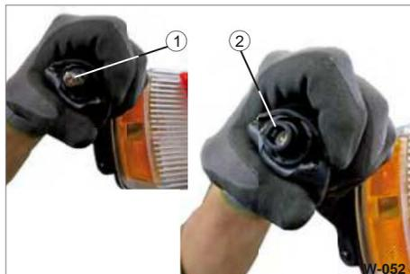
Fig. 60 Sostituzione della lampada
