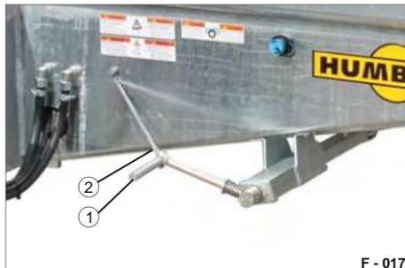
Fig. 19 Freno di stazionamento del mandrino fissato
