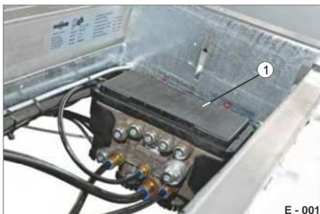
**Fig. 1 Modulo freno, programmabile**
