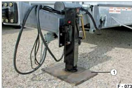
Fig. 46 Piede di appoggio stabilizzato
