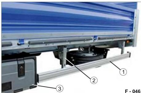
Fig. 68 SSE in posizione di guida
