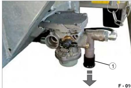
Fig. 12 Freno di servizio in posizione di guida
