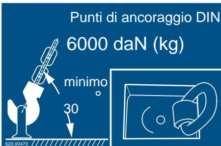
Fig. 139 Esempio di anello di ancoraggio per segnaletica
