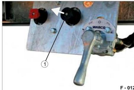
Fig. 14 Freno di servizio in posizione di guida
