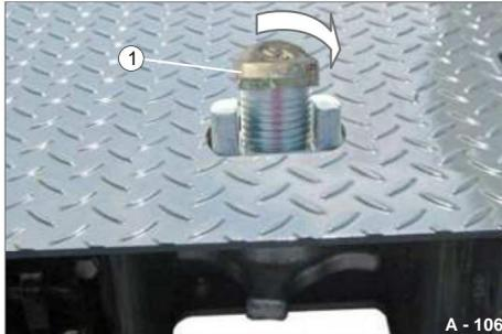
Fig. 159 Allentare il perno del perno
