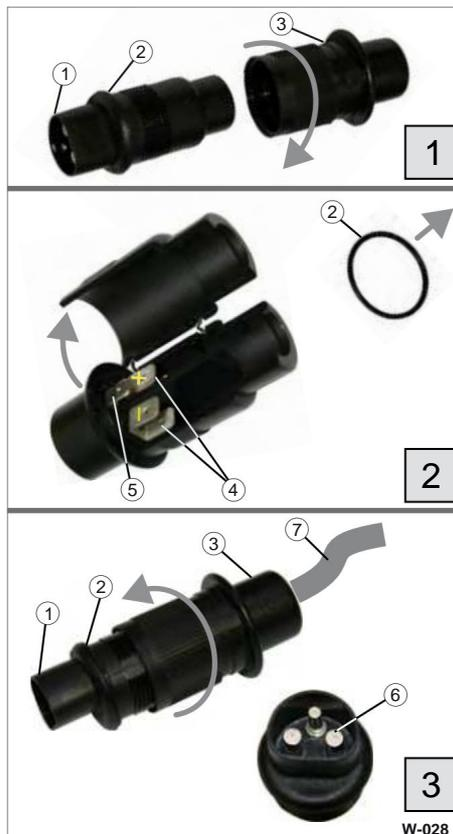
Fig. 32 Spina di ricarica per caricabatterie
