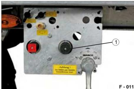
Fig. 13 Rilascio del freno di servizio
