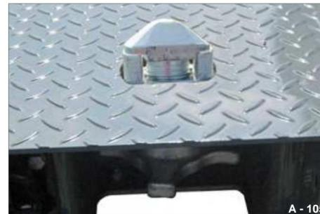
Fig. 158 Bloccaggio in posizione di ricezione
