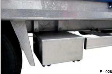
Fig. 43 Scatola della batteria sul lato sotto il telaio
