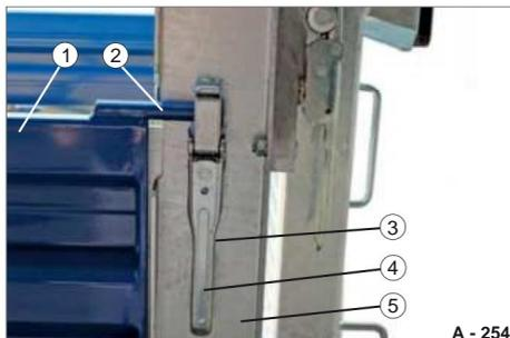
Fig. 117 Serratura della parete laterale CHIUSA
