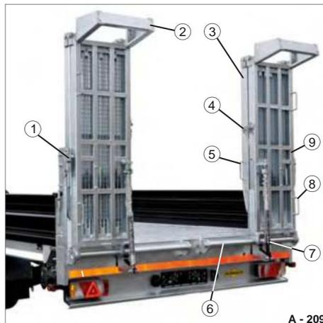
Fig. 35 Rampe di carico
