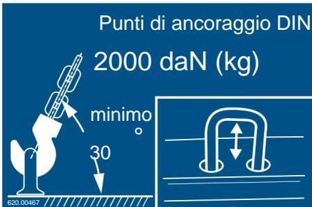
Fig. 138 Esempio di staffa di ancoraggio per segnaletica
