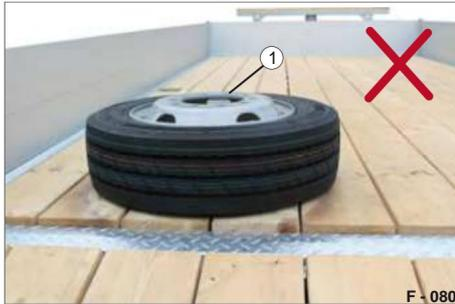
**Fig. 83 Ruota di scorta non fissata**
