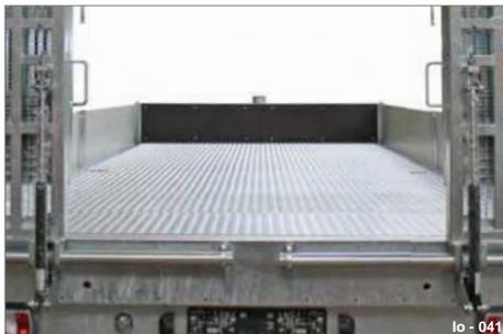
Fig. 24 Lamiera a scacchi in alluminio
