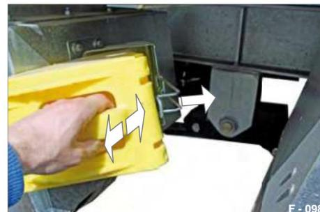
Fig. 91 Azionamento del cuneo di bloccaggio
