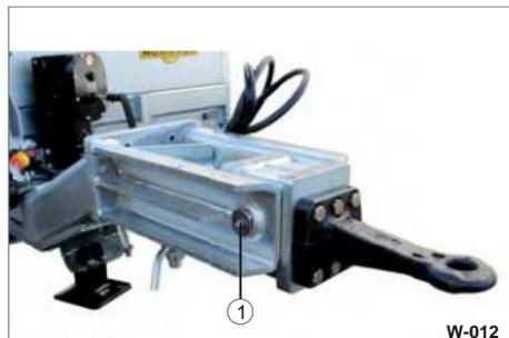
Fig. 15 Lubrificazione dell'asse girevole
