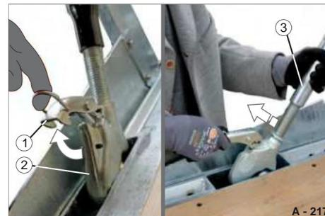
Fig. 56 Sblocco della barra di sicurezza inferiore 1
