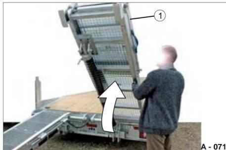
**Fig. 108 Sollevamento della rampa di accesso in due parti**
