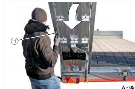
Fig. 90 Abbassamento della rampa di accesso
