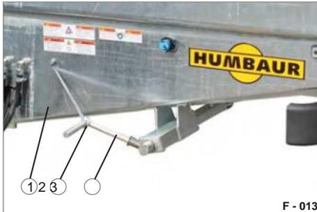
Fig. 15 Freno di stazionamento del mandrino fissato in posizione di guida
