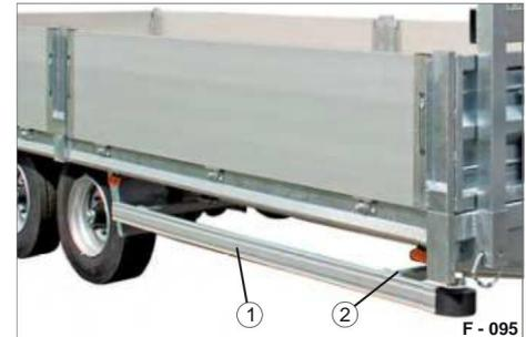
Fig. 67 SSE fissato
