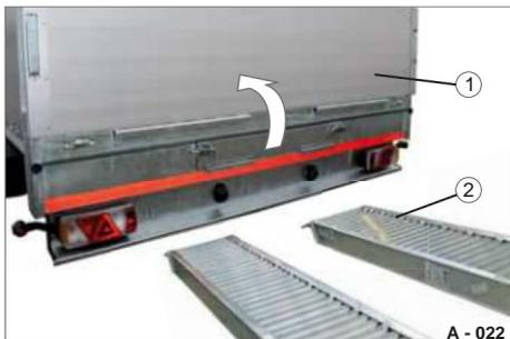
Fig. 28 Chiusura della parete laterale posteriore
