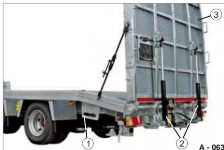
Fig. 101 Parete di rampa idraulica
