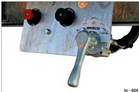
Fig. 25 Punto di controllo posteriore per la regolazione dell'altezza del telaio
