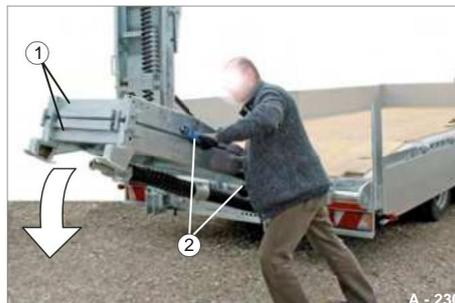
Fig. 94 Abbassamento della rampa di accesso
