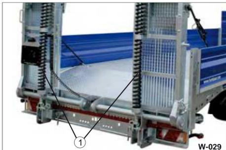
Fig. 33 Meccanismo di sollevamento a molla per rampe di accesso
