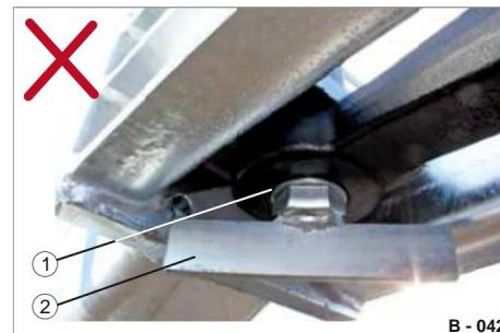
Fig. 28 Fissaggio non corretto - vista sotto
