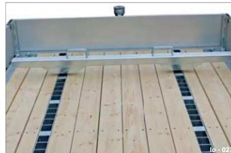
Fig. 28 Binario di sicurezza come fermaruota
