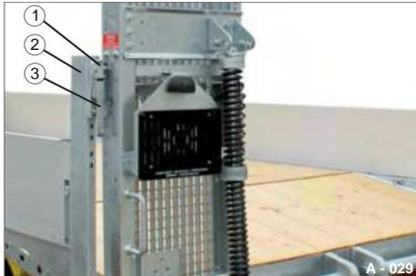
**Fig. 40** Rampe con blocco di sicurezza 1 Blocco di sicurezza 2 Montante angolare 3 Maniglia di bloccaggio
