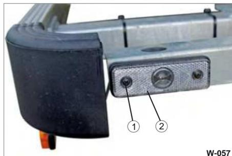
Fig. 68 Luce di posizione laterale anteriore
