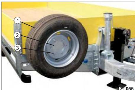
Fig. 77 Ruota di scorta sul pannello anteriore
