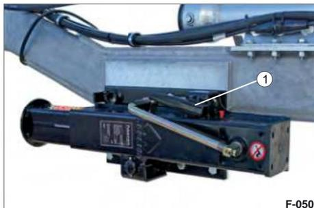
Fig. 52 Supporto girevole / posizione di guida
