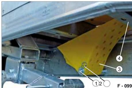
Fig. 92 Cuneo di bloccaggio ruota parcheggiato sotto il telaio nella parte posteriore
