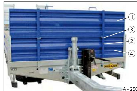
Sl. 185 Pričvršćivanje bočnog zida od čelika
