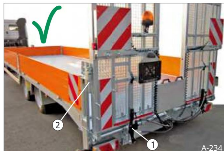
Sl. 111 Pristupne rampe, osigurane
