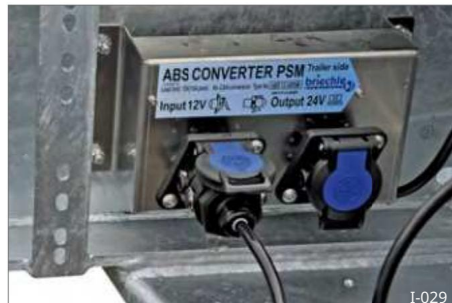
Sl. 32 Pretvarač napona (12 V - 24 V)
