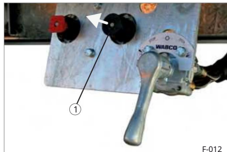
Sl. 14 Radna kočnica u položaju za vožnju
