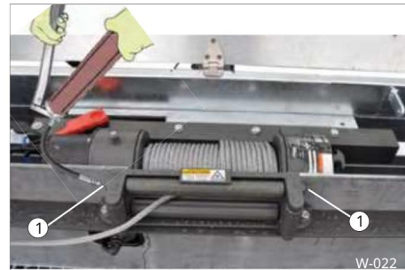
Sl. 26 Primjer: Podmazivanje valjaka s uputama
