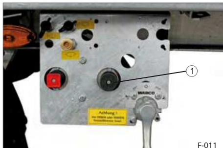
Sl. 13 Otpuštanje radne kočnice
