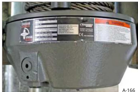
Sl. 214 Primjer: Tipska pločica na vitlu
