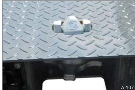
Sl. 160 Zaključano (prijevoz kontejnera)
