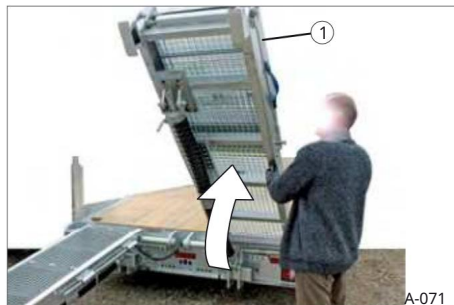
Sl. 108 Podizanje pristupne rampe u dva dijela
