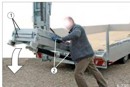
Sl. 94 Spuštanje pristupne rampe
