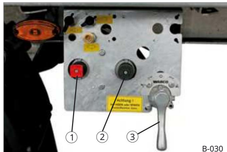
Sl. 35 Zatezanje parkirne kočnice (HBTZ 19 t)
