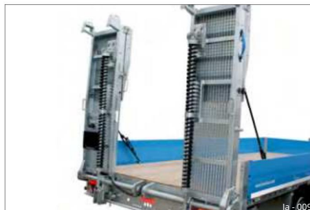
Sl. 8 Podjela 1/3, s mehanizmom za podizanje oprugom
