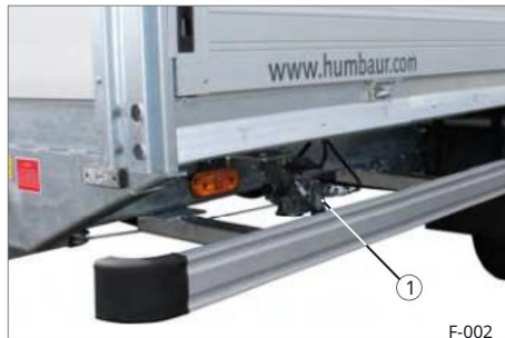
Sl. 2 Upravljački elementi - Strana u smjeru vožnje tung poveznice 1 otpusni ventil radne kočnice (HBT BE / HBT BS / HBTZ BS 13 t)
