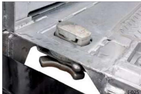
Sl. 26 Zaključavanje spremnika "Twist-Lock"
