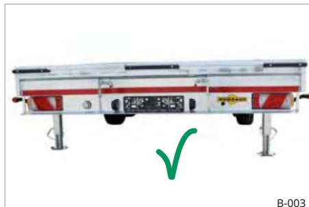
Sl. 3 Sklopivi nosači sklopljeni prema dolje
