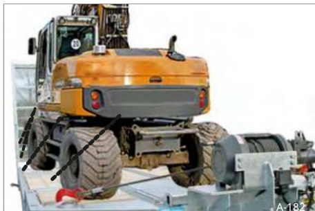
Sl. 228 Primjer: Teret / vozilo osigurano
