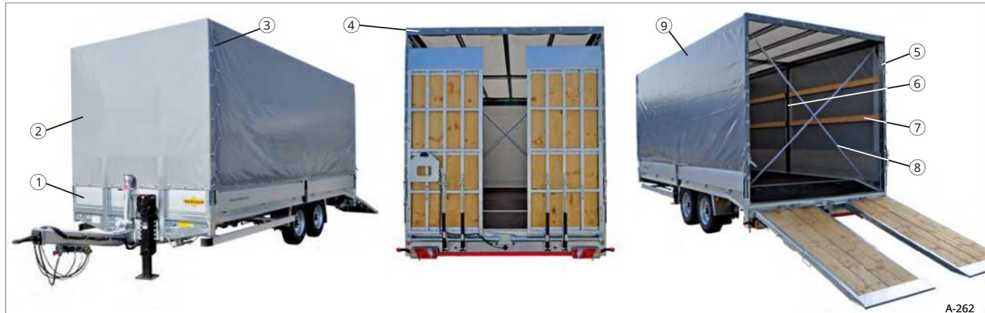
Sl. 204 Primjer: Prikolica s pramčanom/ceradnom konstrukcijom
