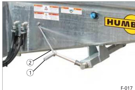
Sl. 19 Kočnica za parkiranje vretena osigurana 1 kurbla 2 sigurnosna užeta s kukama
