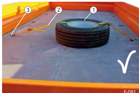
Sl. 84 Primjer: Rezervni kotač pričvršćen 1 Rezervirano
