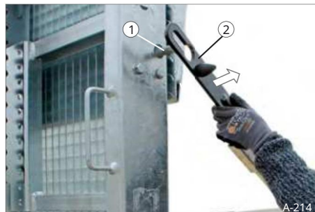
Sl. 52 Uklonite sigurnosnu stezaljku 1 konus 2 sigurnosne stezaljke
