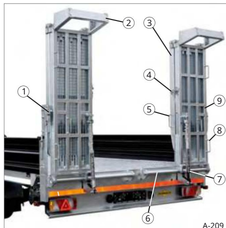
Sl. 35 HBT BS 13 t utovarne rampe s plinskim oprugama
