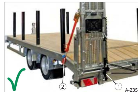
Sl. 112 Pristupne rampe, osigurane
