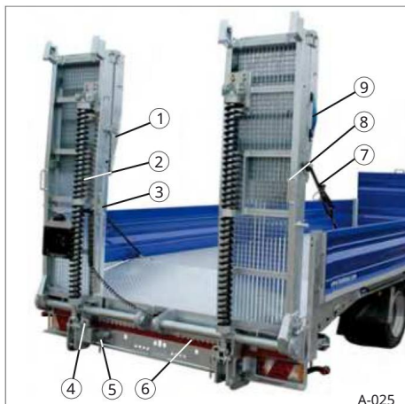
Sl. 34 HBT BS 13 t pristupne rampe s mehanizmom za podizanje oprugom
