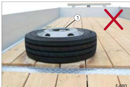
Sl. 83 Rezervni kotač nije pričvršćen 1 Rezervirano labavo
