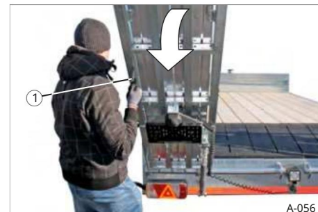
Sl. 90 Spuštanje pristupne rampe
