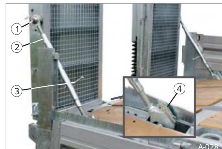
Sl. 39 Utovarne rampe sa sigurnosnom prečkom
