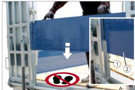
Sl. 195 Umetanje bočne stijenke s utikačem
