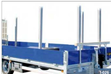
Fig. 27 Støtteben, stikbare / aftagelige
