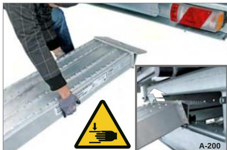
Fig. 8 Løftning af ramperne
