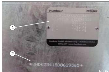
Figur 39 Køretøjets front 1 typeplade 2 indgraverede stelnummer
