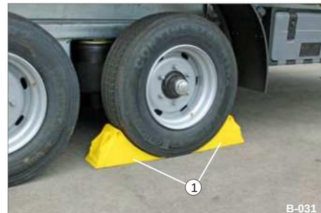
Fig. 36 Hjulklodser påsat 1 hjulklods
