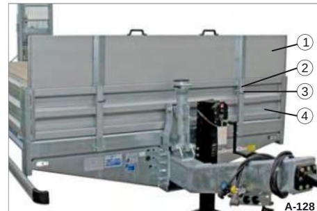
Fig. 184 Sidevægsfastgørelse af aluminium
