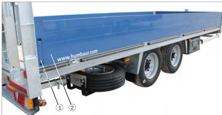
Fig. 113 Sidevægge - Udførelse: Aluminium
