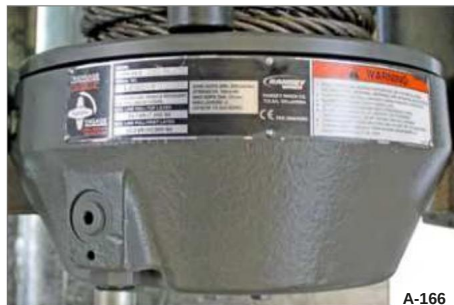
Fig. 214 Eksempel: Typeskilt på kabelspillet
