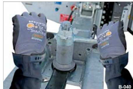
Fig. 26 Spændeøjer D40 fastgjort
