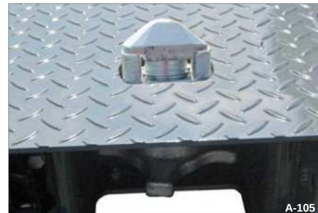
Fig. 158 Låsning i modtageposition
