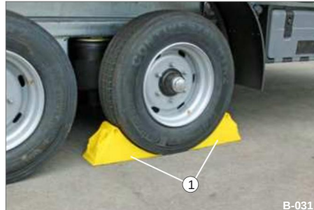
Fig. 20 Anhænger fastgjort 1 hjulkodser placeret under
