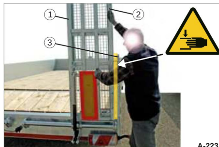
Fig. 75 Flytning af tilkørselsrampen 1 adgangsrampe 2 Klo 3 hjørnepæle
