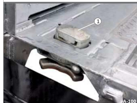
Fig. 153 Containerlåsning 1 låsepunkt "Twist-Lock"
