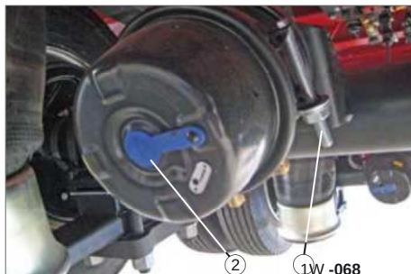
Fig. 53 Fjederbelastet membrancyliner 1 udløsserskrue 2 hætter (hul)
