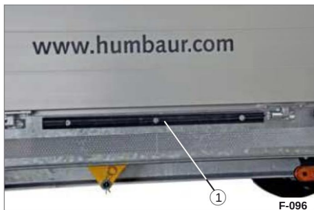
Figur 85 Sidekollisionsbeskyttelse 1 styrtbøjle, delt
