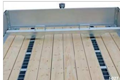
Fig. 28 Sikkerhedsgelænder som hjulstop
