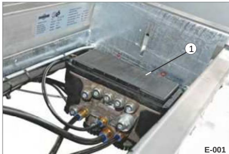
Fig. 1 Bremsemodul, programmerbart 1 Bremsen-Modul (EBS-Modulator)
