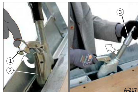
Fig. 56 Udløsning af den nederste sikkerhedsstang 1
