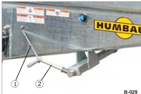
Fig. 34 Spindelparkeringsbremse (HBT BE / HBT BS / HBTZ BS 13 t)
