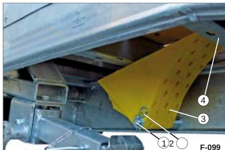
Fig. 92 Hjulklods parkeret under chassiset bagtil
