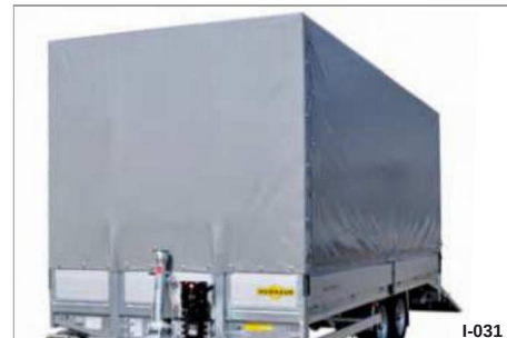
Fig. 29 Buespant med fuld presenning
