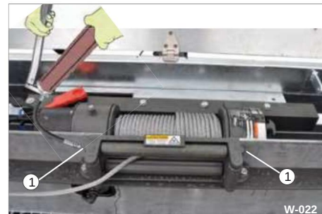
Fig. 26 Eksempel: Smøring af instruktionsrullerne
