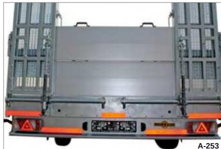
Fig. 193 Indstikssidevæg dobbelt oven på hinanden
