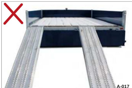
Fig. 22 Ramper - ikke placeret proportionalt
