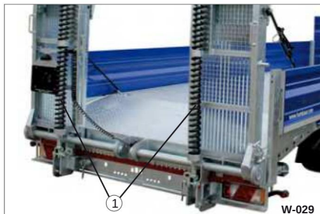
Fig. 33 Fjederløftmekanisme til adgangsramper
