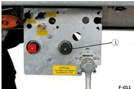
Fig. 13 Udløsning af driftsbremsen
