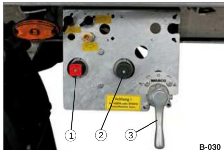
Fig. 35 Aktivering af parkeringsbremsen (HBTZ 19 t)
