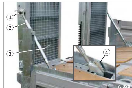
Fig. 39 Læsseramper med sikkerhedsbøjle
