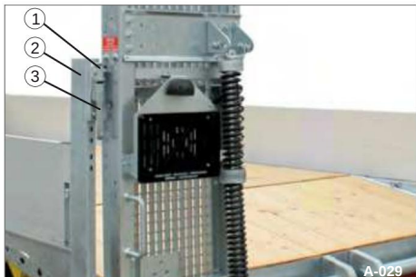
Fig. 40 Ramper med sikkerhedslås
