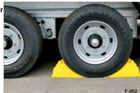
Fig. 88 Eksempel: Hjulklodser placeret under
