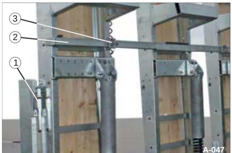
Fig. 42 Tre adgangsramper med sikkerhedslås og stænger
