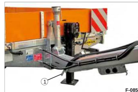
Fig. 36 Parkering af hydraulikledningen
