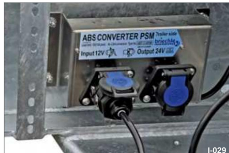
Fig. 32 Spændingsomformer (12 V - 24 V)
