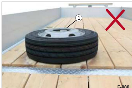
Fig. 83 Reservehjul ikke fastgjort 1 Reserveret løs
