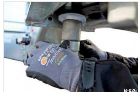
Fig. 23 Spændeøjer D50 fastgjort
