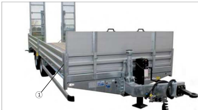
Fig. 114 Sidevægge - Udførelse: Stål
