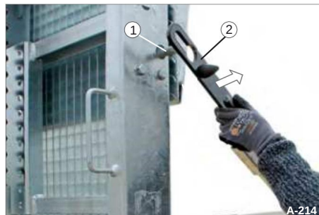
Fig. 52 Fjern sikkerhedsklemmen 1 kegle 2 sikkerhedsklemmer
