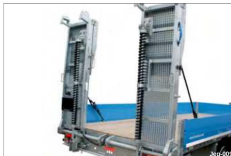
Fig. 8 1/3-delning, med fjederløftmekanisme
