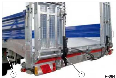
Fig. 35 Sænkning af ramperne
