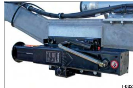
Fig. 34 monteret på rørtrækstang
