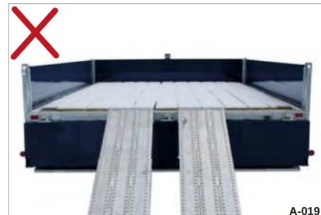
Fig. 24 Læsseramper - for langt indad
