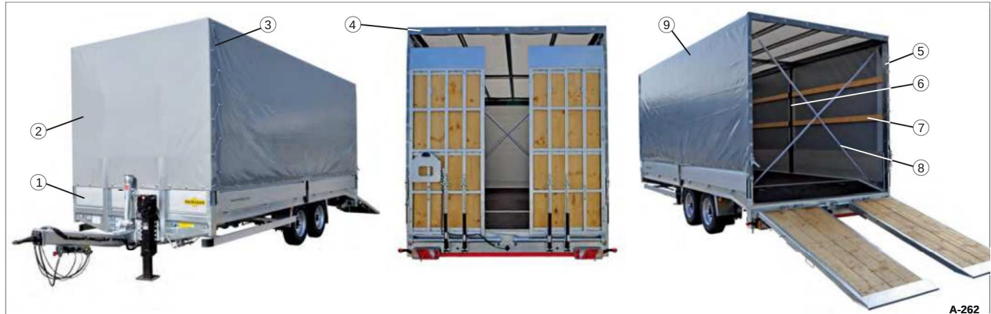
Fig. 204 Eksempel: Trailer med bov-/presenningsstruktur
