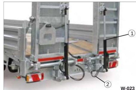
Fig. 27 Kontrol/service af cylindre
