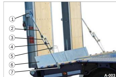
Bild 3 Ramper säkrade med spännskruv (med rampskyddsplatta)
