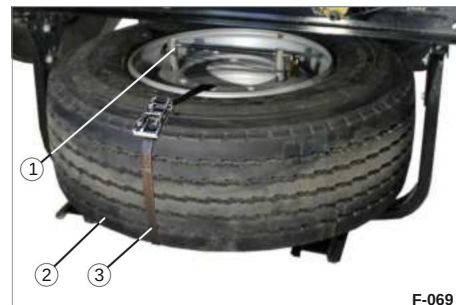
Bild 78 Defekt hjul säkrat
