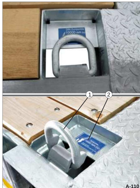
Bild 127 Surringspunkt, lastutrymmets ovasida: 10 000 daN (kg)
