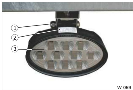
Bild 59 Montering av arbetslampa
