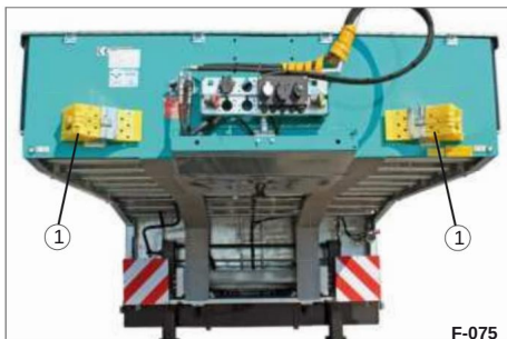
Bild 103 Hjulklossar horisontellt, i fästfästen (stålplåt)
