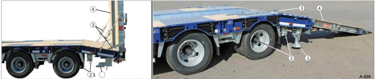
Bild 27 Lastramper säkrade i körläge och nedsänkta för lastning/lossning
