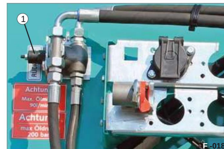
Fig. 26 Flödesfördelare Qmax.=90 l/min 1 tryckreduceringsventil
