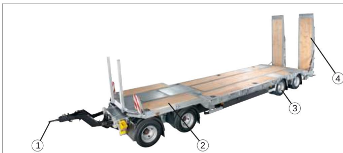
Bild 3 Vänbord "HTD 40 95 25-K" 1 Dragstång / dragstångsförskjutning 2 Plåtå, förskjuten 3 Axlar, 4x 4 Lastramper, i ett stycke / hydrauliska
