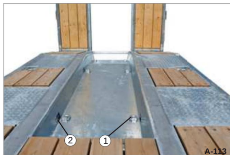
Bild 130 Surringspunkt, i grävmaskinens bomtråg: 3 000 daN (kg)
