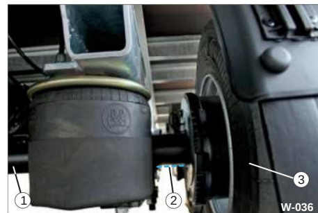
Bild 36 Montering av lyftanordningen
