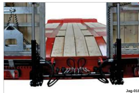
Bild 11 Hydraulcylinder för sidoförskjutning av ramperna
