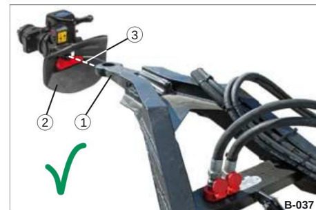
Bild 47 Höjden är korrekt inställd
