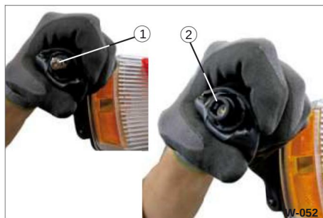
Bild 52 Byte av lampa
