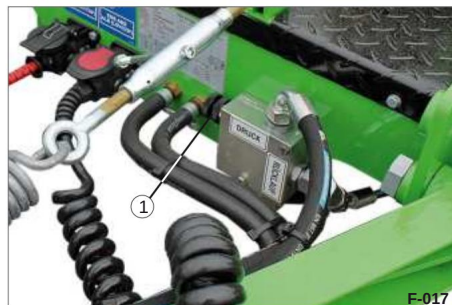
Fig. 25 Flödesfördelare Qmax.=150 l/min 1 tryckreduceringsventil
