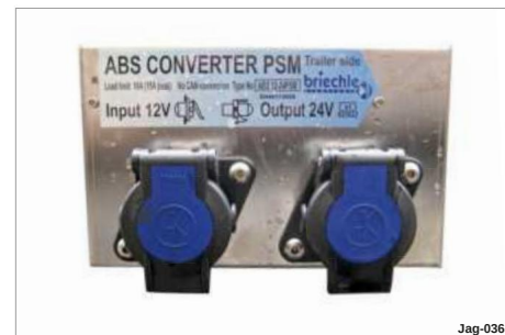
Bild 29 Spänningstransformator EBS / ABV
