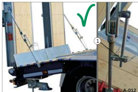
Bild 11 Spännskruv säkrad 1 säkerhetsnål
