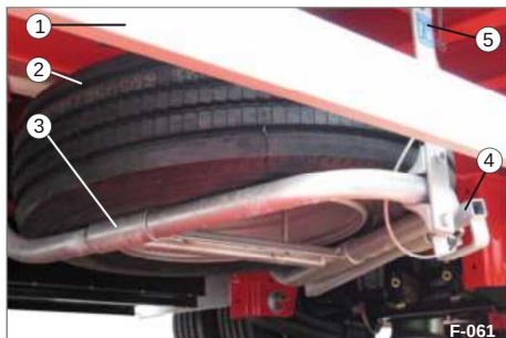
Bild 79 Reservhjul säkrat - Variant 1
