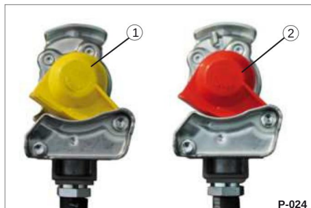
Bild 11 Broms-/matningsledning frånkopplad 1 broms (gul) 2 förnödenheter (röd)
