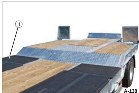
Bild 147 Golvbeläggning av gummi
