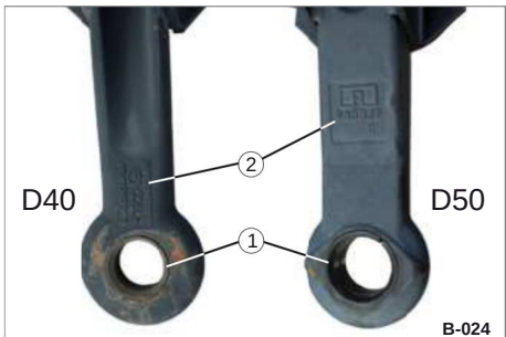
Bild 9 Smörjning av dragöglor / slipolja svamp
