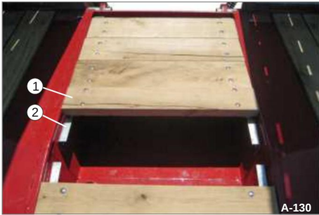
Kuva 121 Kaivinkoneen puomin kourun tiivistäminen 1 puinen lankku 2 tukilevyn kulmaa
