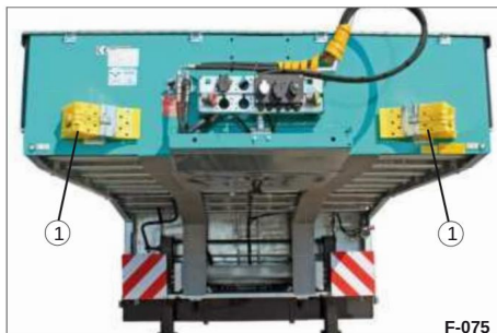
Kuva 103 Pyöräkiilat vaakasuorassa, kiinnityksraudoissa (teräslevy)
