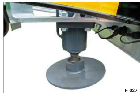
Kuva 60 Hydraulinen laskutelineet, nostettuna (ajoasento)
