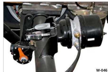
Kuva 45 Jousen jännityksen vapauttaminen
