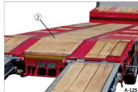
Kuva 117 Kaivinkoneen puomin kouru
