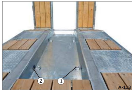
Kuva 130 Kiinnityskohta kaivinkoneen puomin kourussa: 3000 daN (kg)
