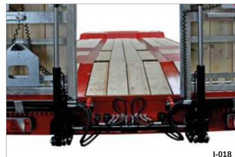
Kuva 11 Hydraulisylinteri ramppien sivuttaissiirtoa varten
