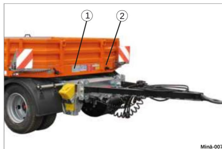
Kuva 31 Ajoneuvon etuosa (kääntölava) 1 Ajoneuvon tunnistenumero (VIN) 2 etupuoli, korkea tasanko
