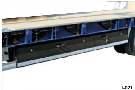
Kuva 14 Säilytyslokero, pituussuunnassa järjestettynä
