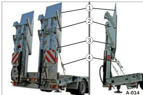
Kuva 13. Jaettujen ramppien kiinnitys
