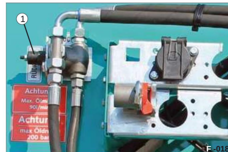
Kuva 26 Virtauksen jakaja Qmax.=90 l/min 1 paineenalennusventtiili
