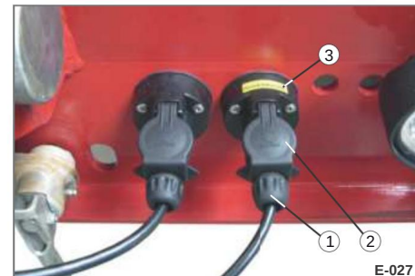
Kuva 22 Pyörivän majakan asettaminen
