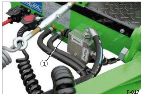
Kuva 25 Virtauksen jakaja Qmax.=150 l/min 1 paineenalennusventtiili
