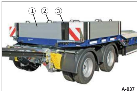
Kuva 37 Sivuseinän rakenne, alumiinia
