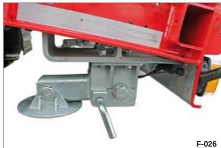
Kuva 58 Manuaalisesti taittuvat tukijalat, ylös käännettyinä (ajoasento)
