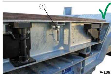
Kuva 115 Suuret pyöräkotelot, lukittuina
