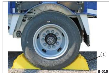
Kuva 98 Pyöräkiilat alle asetettuina 1 pyöräkiila
