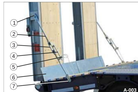
Kuva 3. Rampit kiinnitetty kiristysruuvilla (rampin peitelevyllä)
