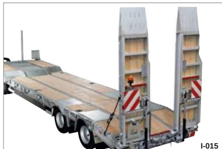
Kuva 8 Yhdestä kappaleesta valmistetut hydrauliset lastausrampit
