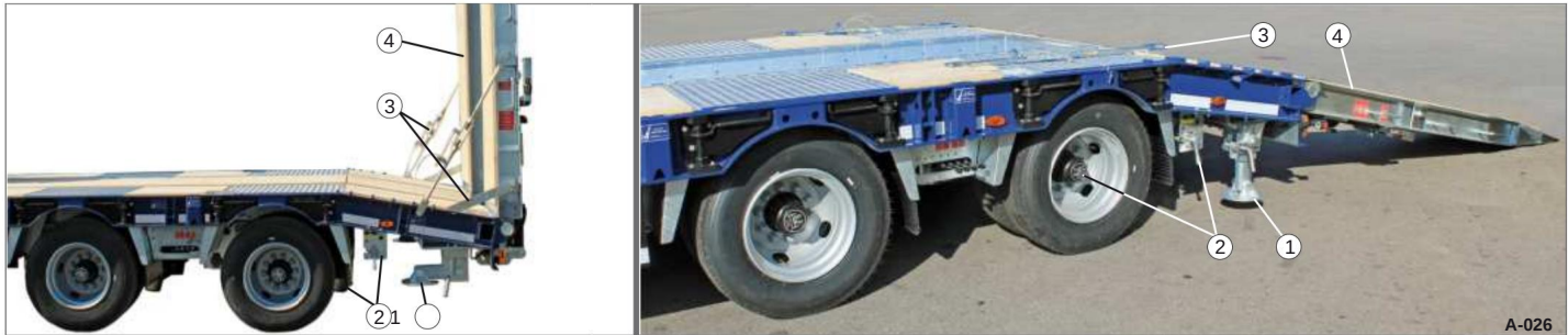
Kuva 27 Lastausrampit kiinnitettynä ajoasentoon ja laskettuna lastausta/purkua varten
