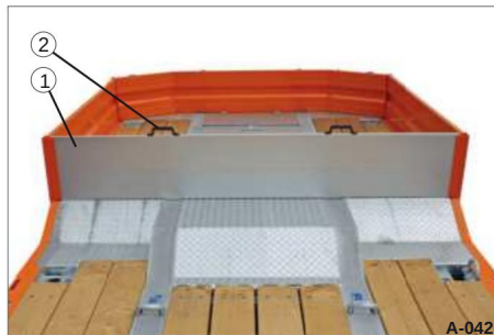
Kuva 40 Alumiininen sivuseinä, työnnettynä
