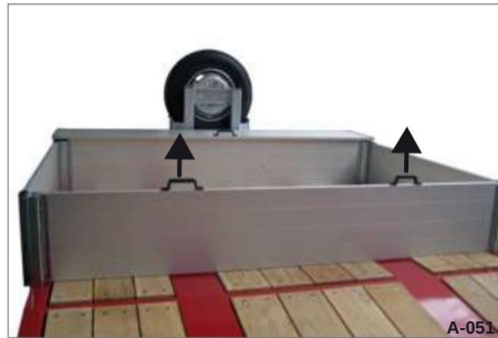
Kuva 59 Pistokeliitántäinen sivuseinä asetettu paikalleen
