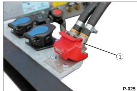
Kuva 12 Duo-Matic-pikakytkentäjärjestelmä 1 kytKentäpäät syöttö- ja jarrukytkimellä
