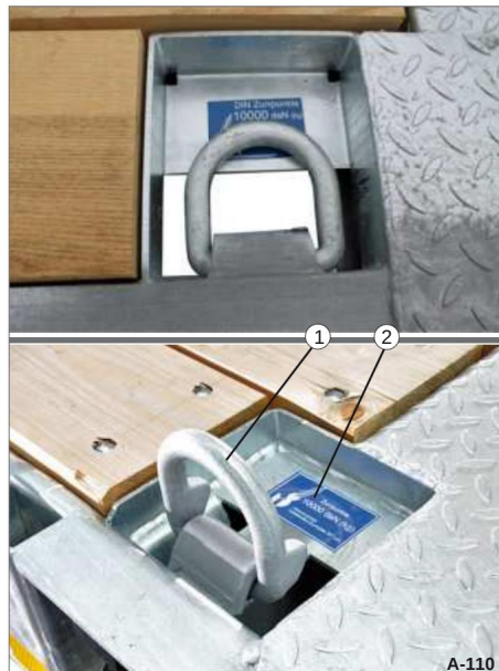
Kuva 127 Kiinnityskohta, lastausalueen yläosa: 10 000 daN (kg)
