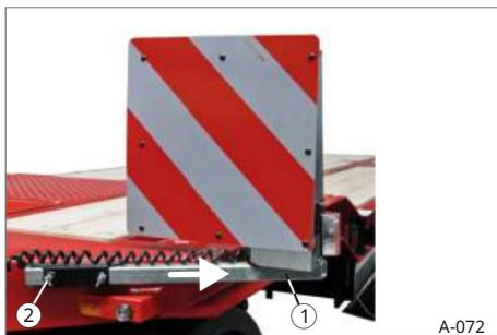
88. ábra Figyelmeztető tábla kihúzva
