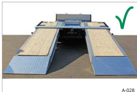
29. ábra Lehajtott rakodórámpák
