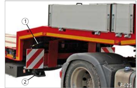
57. ábra Felemelt támasztőlábak
