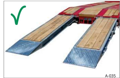
35. ábra Leengedett rakodórámpák
