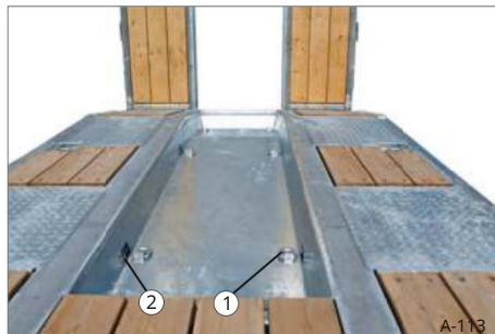
130. ábra Rögzítési pont a kotrógép gémtelknőjében: 3000 daN (kg)
