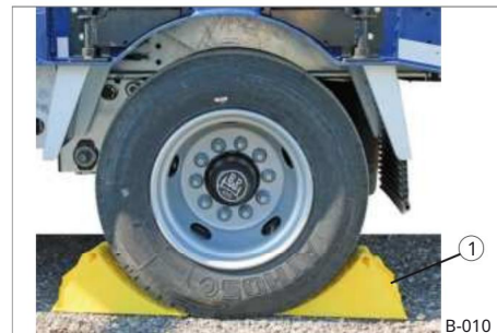
15. ábra Kerékfekek elhelyezése
