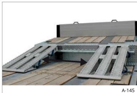
154. ábra Nyomtáv beállítva
