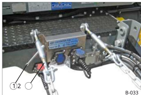
49. ábra Magasságállító tás - 1. változat
