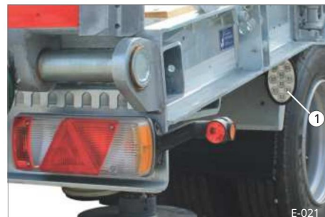
16. ábra Az oldalsó munkalámpák elhelyezkedése
