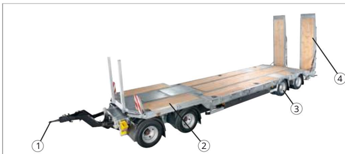
3. ábra "HTD 40 95 25-K" forgózsámoly 1 Vonórúd / vonórúd eltolás 2 Plató, eltolás 3 Tengelyek, 4x 4 Rakodórámpák, egyrészes / hidraulikus
