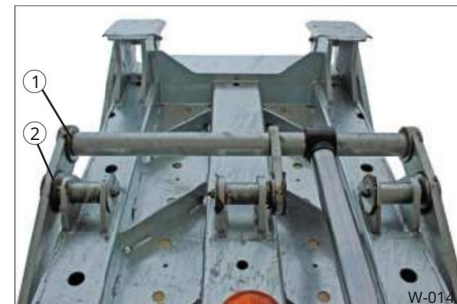
21. ábra Csapágyak kenése
