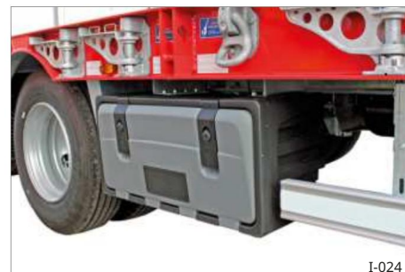
17. ábra Szerszámoszláda, oldalnézet
