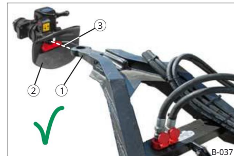
47. ábra A magasság helyes beállítása
