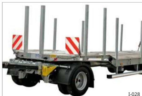
21. ábra Rakoncák, dugaszolható/levegő
