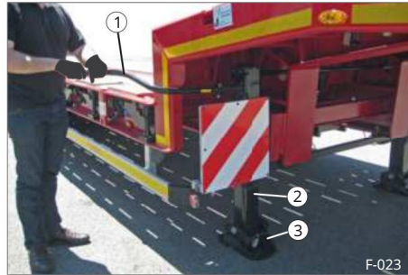
56. ábra A támasztőlábak leengedése
