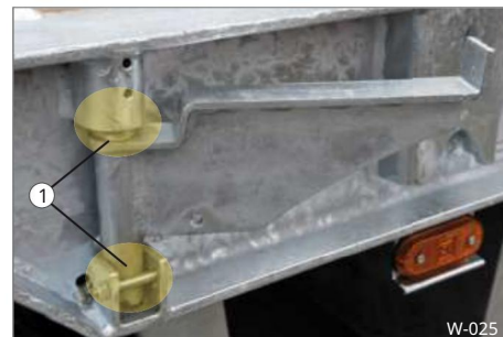
24. ábra Csapágyak kenése
