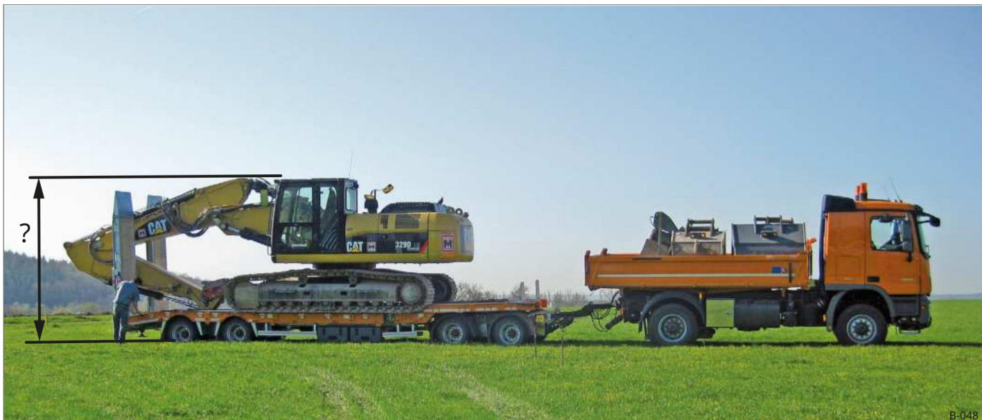
58. ábra A megrakott mélybölcsős teljes magassága
