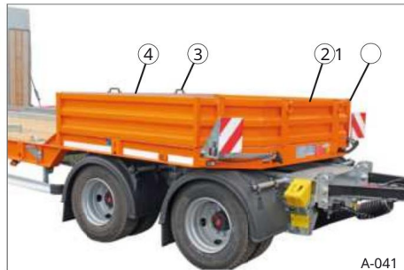
39. ábra Oldalfal szerkezet, acél
