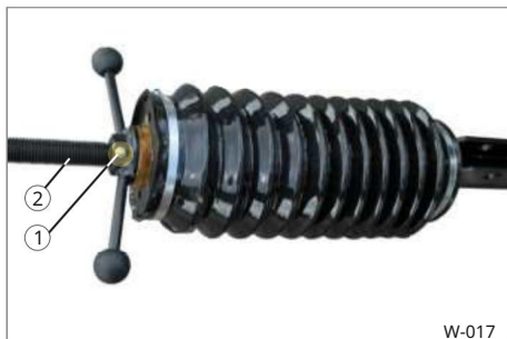
13. ábra A magasságállítás kenése
