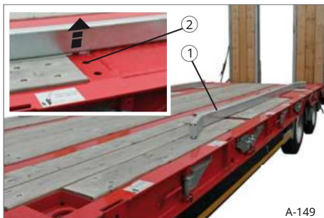
145. ábra A biztonsági korlátok mozgatása
