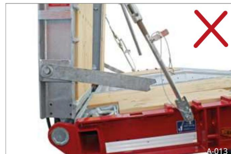
12. ábra A feszítőcsavar nincs rögzítve
