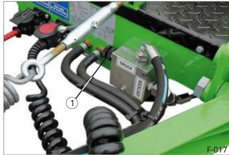
25. ábra Átfolyáselosztó Q_{max}=150 \text{ l/min} 1 nyomáscsökkentő szelep
