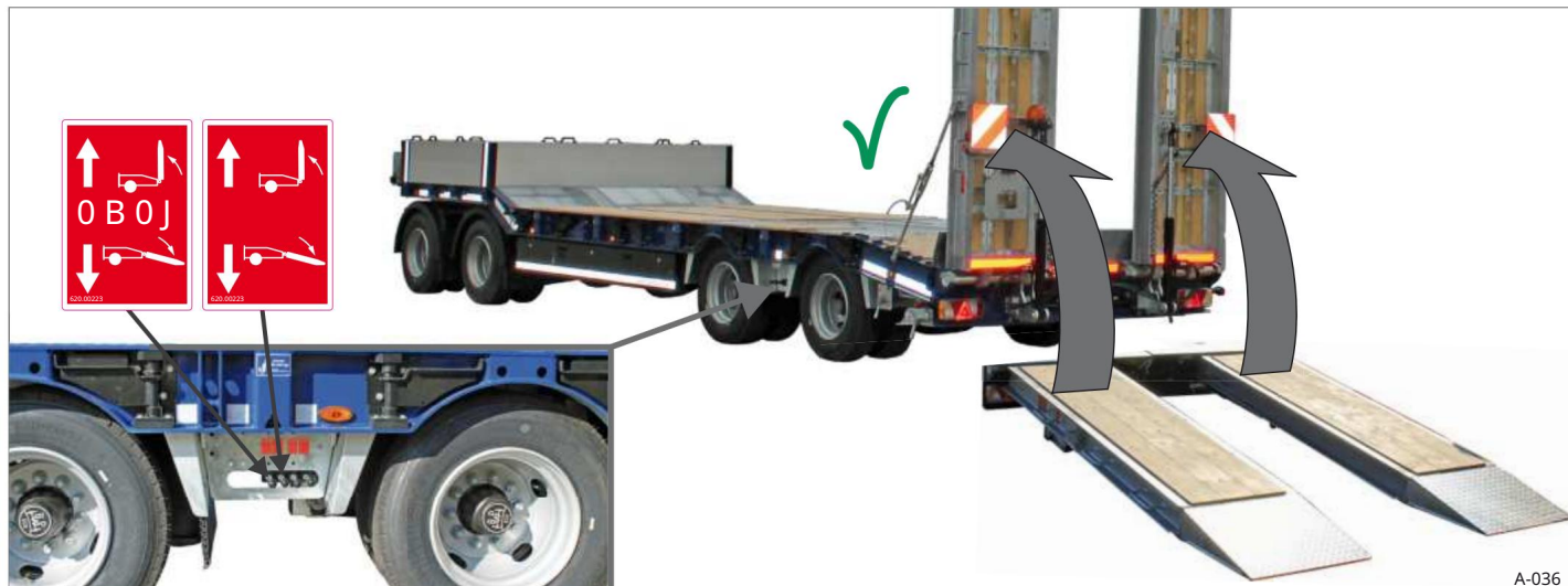
36. ábra A felhajtórámpák felemelése
