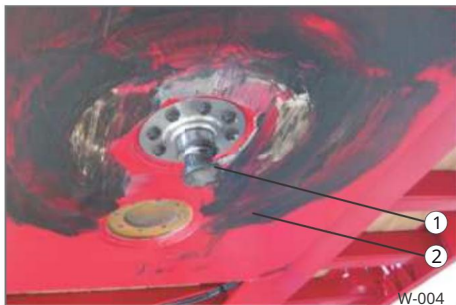
4. ábra Kenje meg a nyeregcsatlakozást
