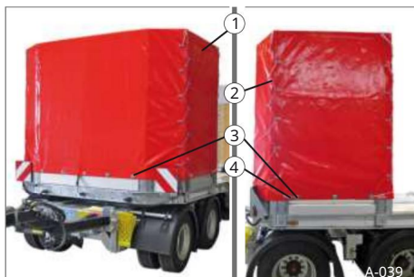
43. ábra Ponyva / orr rögzítése
