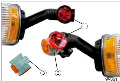
51. ábra A gumikar eltávolítása
