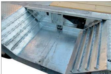
12. ábra Nyitott kerékjárat í v
