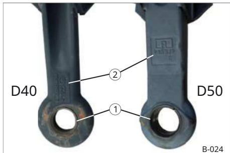
9. ábra A húzószemek kenése / csiszolóolaj gomba
