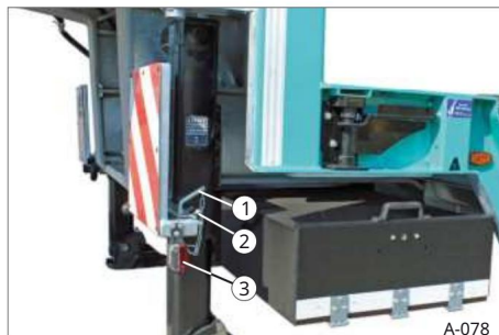
94. ábra Figyelmeztető tábla behúzva
