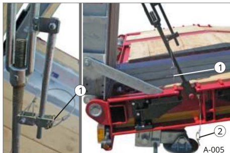
4. ábra A feszítőcsavar kioldva
