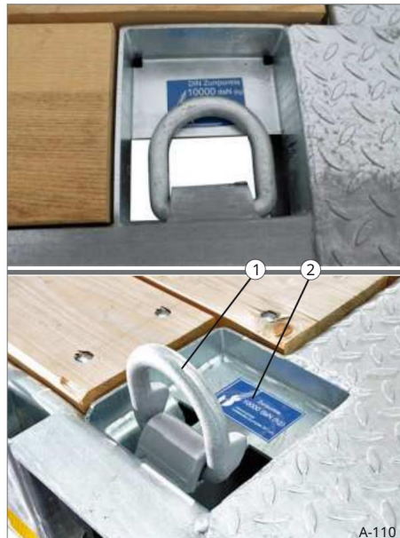
127. ábra Rögzítési pont, a rakodótér teteje: 10 000 daN (kg)
