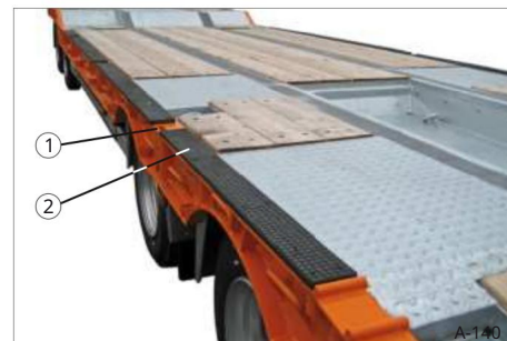
149. ábra Gumiszőnyegek a behajtótérhez
