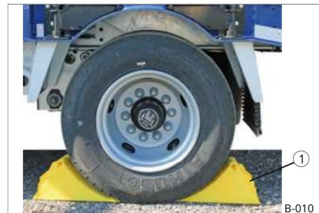
21. ábra Kerékékek elhelyezése
