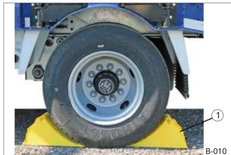
44. ábra Kerékékek behelyezve
