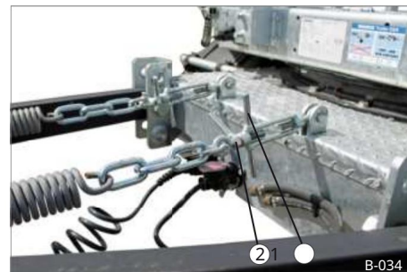
50. ábra Magasságállító tás - 2. változat
