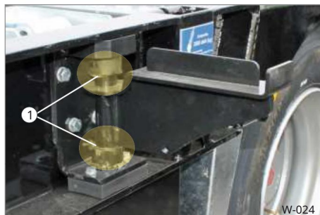
23. ábra Csapágyak kenése
