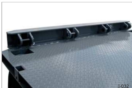
25. ábra További rakományrögzítő tők pontok
