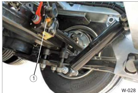
28. számú melléklet 1 kenési pont (zsírzógombok)
