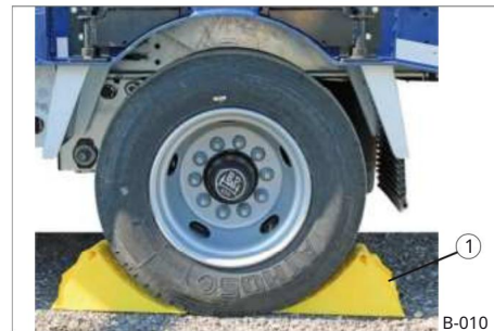
Sl. 98 Klinovi za kotače postavljeni ispod
