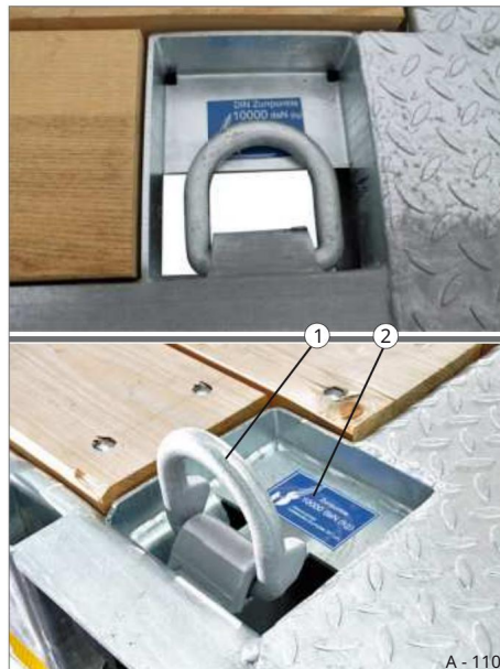
Sl. 127 Točka za pričvršćivanje, vrh utovarnog prostora: 10.000 daN (kg)
