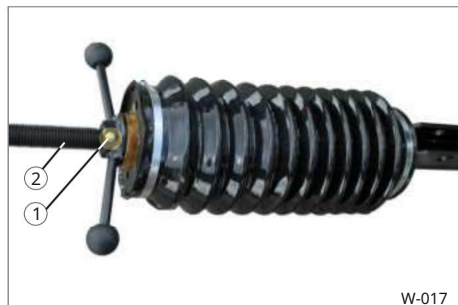
Sl. 13 Podmazivanje podešavanja visine
