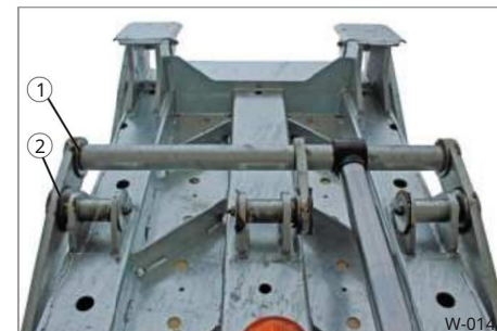
Sl. 21 Podmazivanje ležajeva
