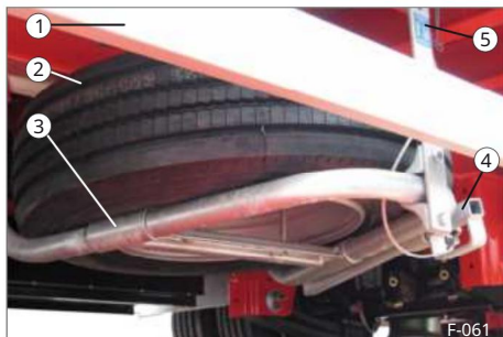
Sl. 79 Rezervni kotač osiguran - varijanta 1
