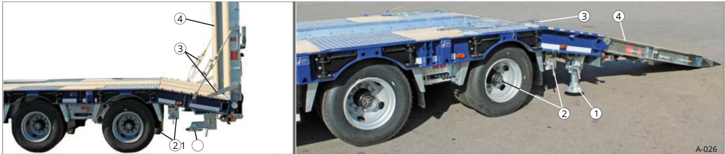
Sl. 27 Utovarne rampe osigurane u položaju za vožnju i spuštene za utovar/istovar
