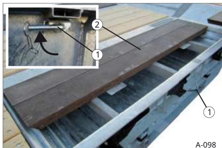
Sl. 107 Uklanjanje pokrovnih ploča
