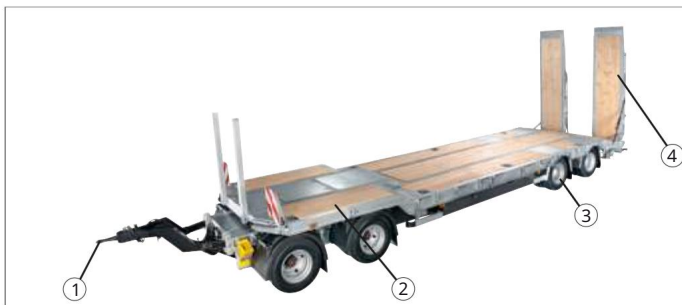
Sl. 3 Okretna ploča "HTD 40 95 25-K" 1 Vučna ruda / pomak vučne rude 2 Plato, pomak 3 Osovine, 4x 4 Utovarne rampe, jednodijelne / hidrauličke
