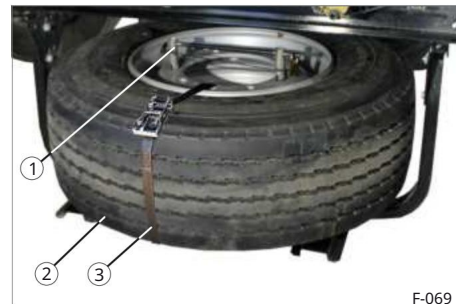
Sl. 78 Neispravan kotač pričvršćen
