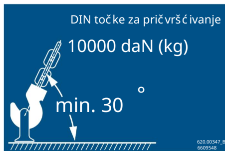
Sl. 124 Primjer: Naljepnica na točki za pričvršćivanje
