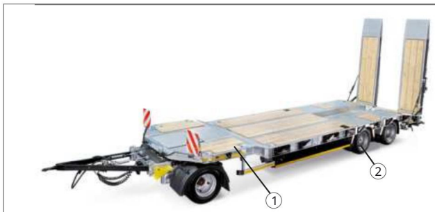
Sl. 2 Okretna ploča "HTD 30 85 25-Ki" 1 platforma, koljenasta 2 osovine, 3x
