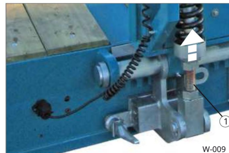
Sl. 33 Opruga, napeta 1 vijak za podešavanje
