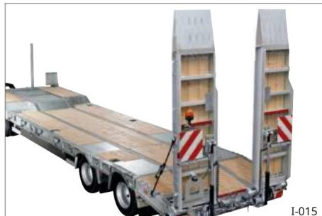
Sl. 8 Jednodijelne hidraulične utovarne rampe
