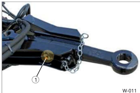
Sl. 10 Podmazivanje okretne osovine
