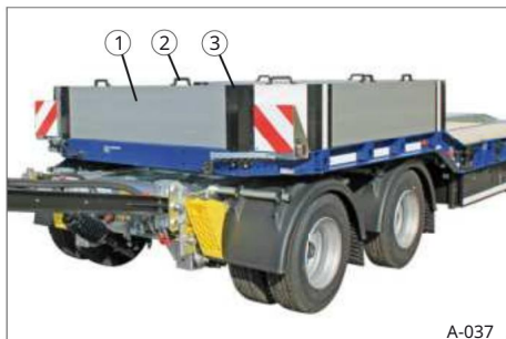
Sl. 37 Konstrukcija bočnih stijenki, aluminij
