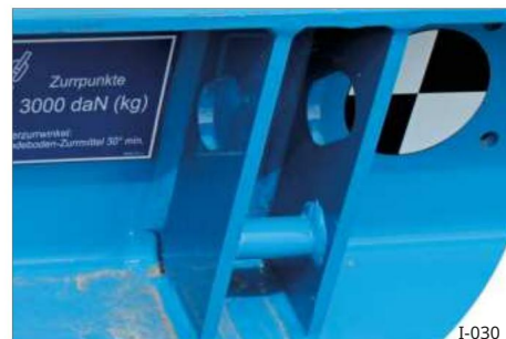
Sl. 23 Točke za pričvršćivanje, bočna strana šasije
