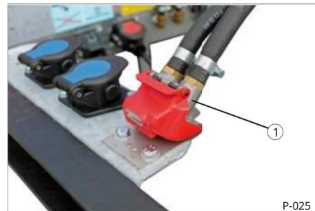
Sl. 12 Duo-Matic sustav brze spojke 1 spojna glava s napajanjem i kočnicom
