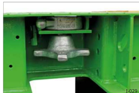
Sl. 22 Uređaji za zaključavanje spremnika
