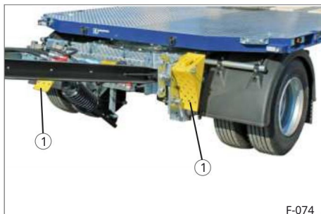
Sl. 99 Klinovi za kotače (2 x) na pričvrstnim vijcima
