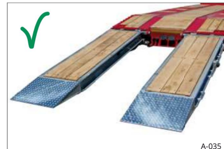
Sl. 35 Spuštene utovarne rampe
