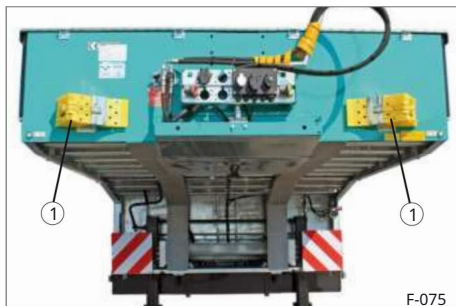
Sl. 103 Klinovi za kotače vodoravno, u nosačima (čelični lim)
