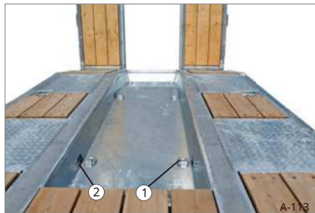
Sl. 130 Točka vezivanja, u koritu grane bagera: 3000 daN (kg)
