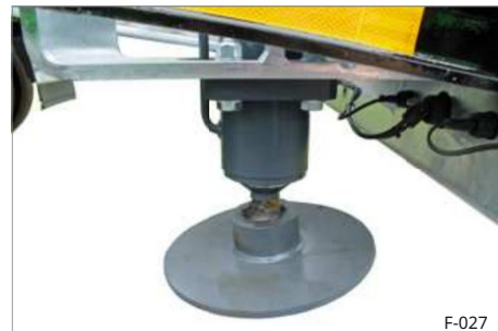
Sl. 60 Hidraulični stajni trap, podignut (položaj za vožnju)
