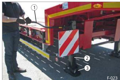
Sl. 56 Spuštanje potpornih nogu
