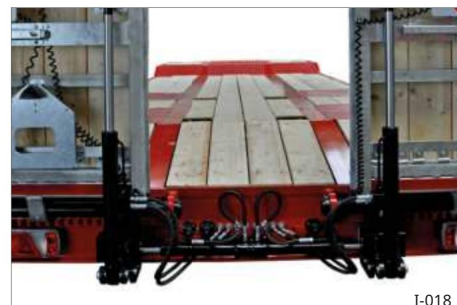
Sl. 11 Hidraulički cilindar za bočno pomicanje rampi
