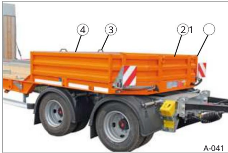
Sl. 39 Bočna zidna konstrukcija, čelik
