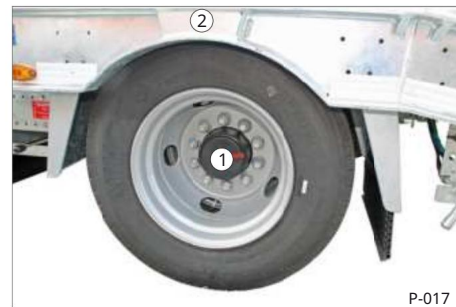
Sl. 38 Položaj ispod 1 sklopa osovine (stražnji kotač) 2 šasije - spuštene
