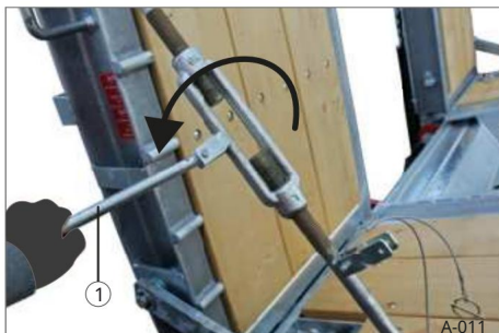
Sl. 10 Zatezanje zatezača 1 Spannhebel
