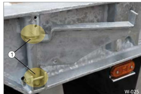
Sl. 24 Podmazivanje ležajeva
