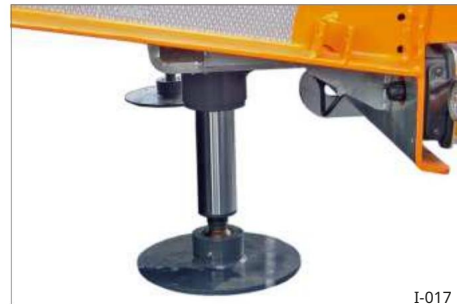
Sl. 10 Stražnji nosači, hidraulični
