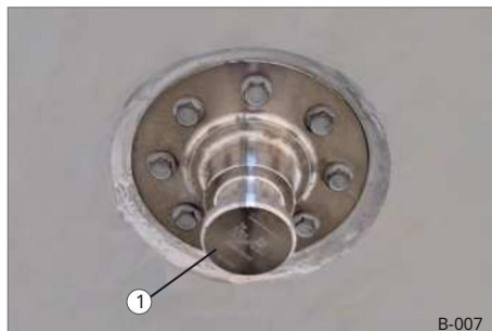
Sl. 12 Spojni element za poluprikolicu s niskim utovarnim prostorom
