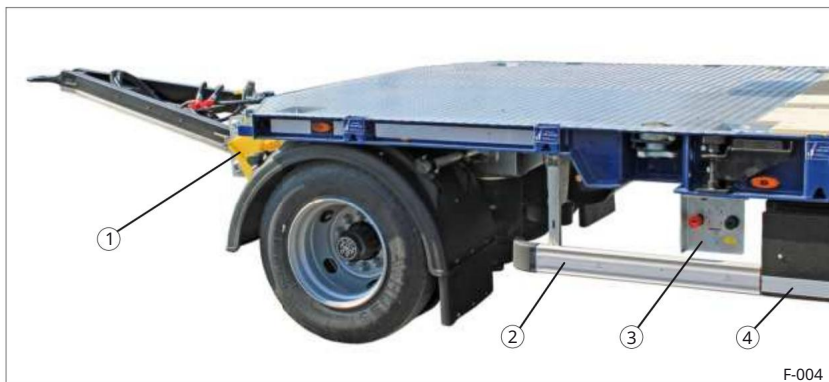
Sl. 4 Upravljanje ravnim platoom šasijske, 3-osovinske
