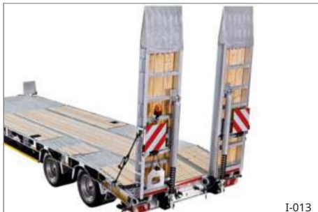
Sl. 6 Jednodijelne rampe (s oprugama)
