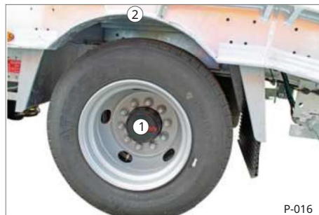
Sl. 37 Položaj iznad 1 sklopa osovine (stražnji kotač) 2 šasije - podignute
