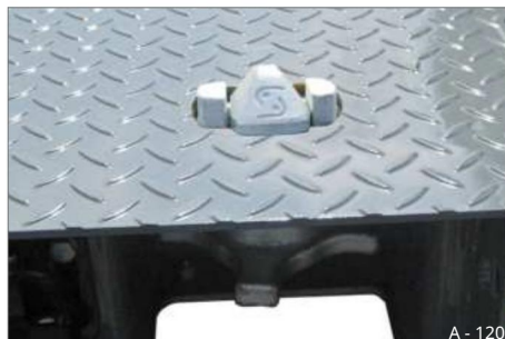
Sl. 142 Zaključano (prijevoz kontejnera)
