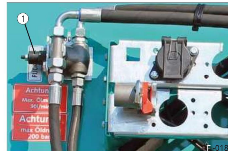
Slika 26 Razdjelnik protoka Q_{max.}=90 \text{ l/min} 1 ventil za smanjenje tlaka
