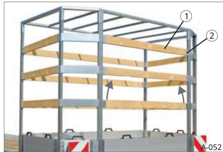
Sl. 44 Uklanjanje/umetanje umetnutih letvica
