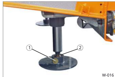
Sl. 12 Podmazivanje nosača
