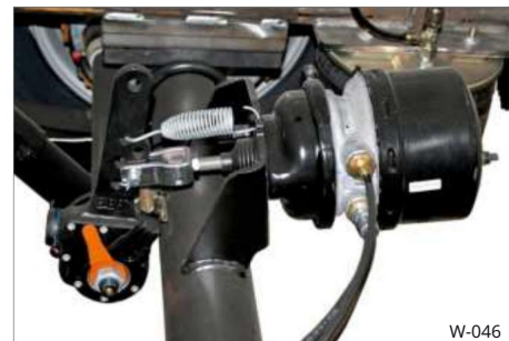
Sl. 45 Otpustite napetost opruge
