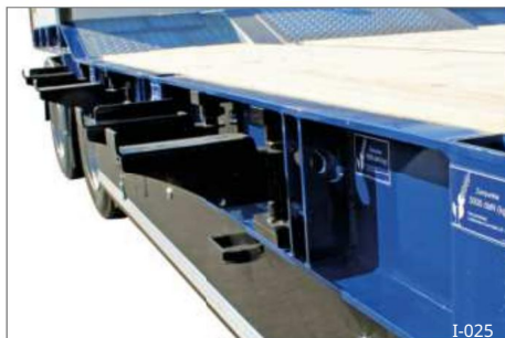
Sl. 18 Sklopiva prečka za drvene daske
