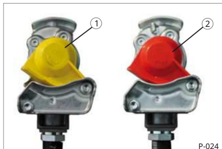
Sl. 11 Kočnica/dovodni vod odspojen 1 kočnica (žuta) 2 pribora (crvena)
