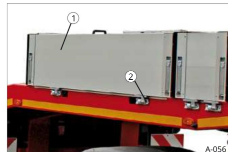
Sl. 51 Bočna stijenka pričvršćena u šarniru
