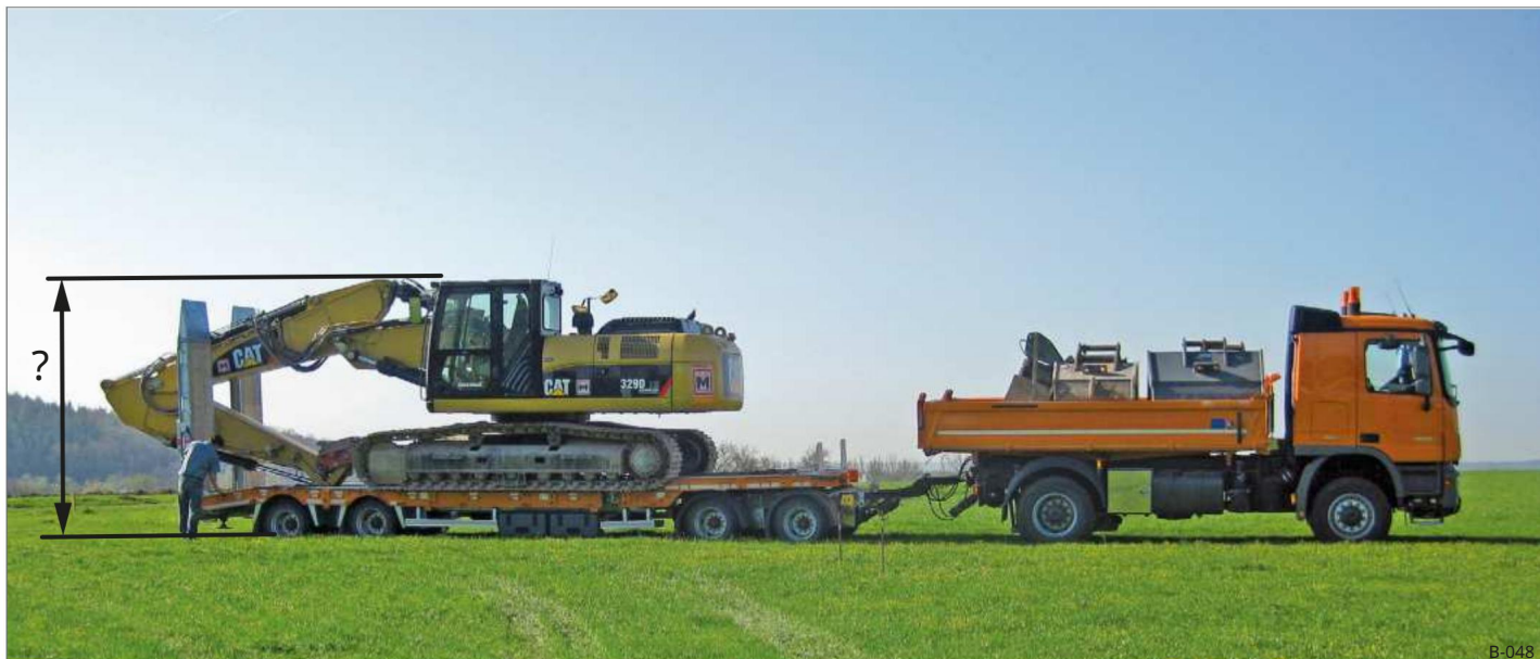
Sl. 58 Ukupna visina natovarenog niskog utovarnog vozila
