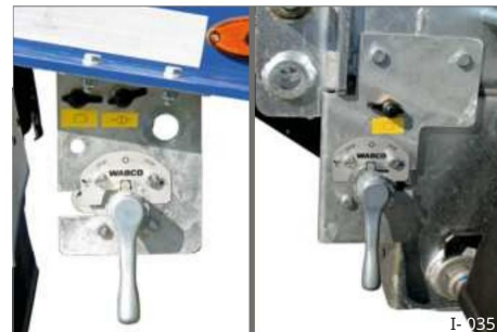
Sl. 28 Sustav za podizanje/spuštanje, opcionalno sprijeda
