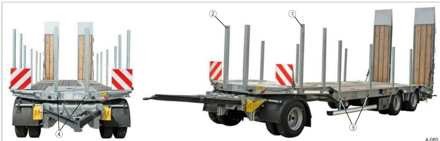
Sl. 98 Niskopodna prikolica s utičnim klinovima
