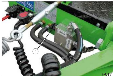
Slika 25 Razdjelnik protoka Q_{max.}=150 \text{ l/min} 1 ventil za smanjenje tlaka
