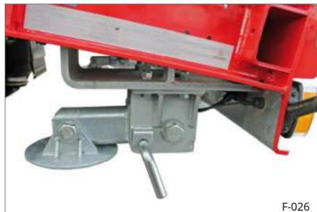
Sl. 58 Ručno sklapanje nosača, sklopljeno prema gore (položaj za vožnju)
