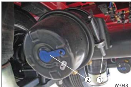
Sl. 46 Opružni membranski cilindar
