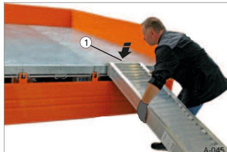
Sl. 56 Ugradnja rampi
