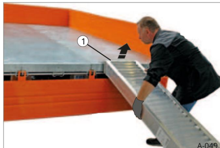
Sl. 59 Spuštanje utovarnih rampi
