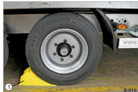
Sl. 21 Postavljeni klinovi za kotače
