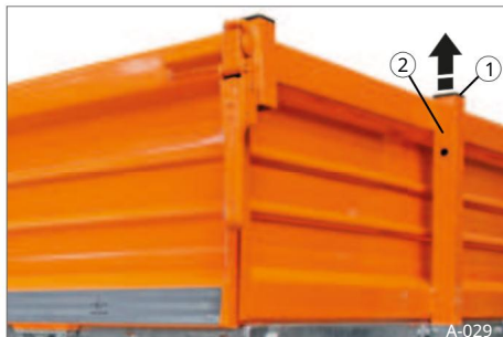
Sl. 37 Priprema potpornog staka za montažu
