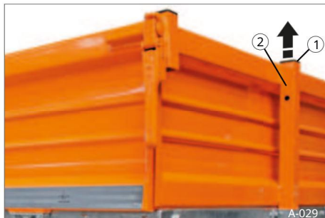
Sl. 42 Priprema pričvrščivanja prednje čelične rešetke
