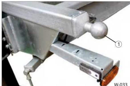
Sl. 33 Kuglica nagibnog ležaja
