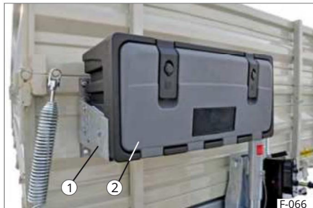
Sl. 91 Kutija s alatom na prednjem zidu
