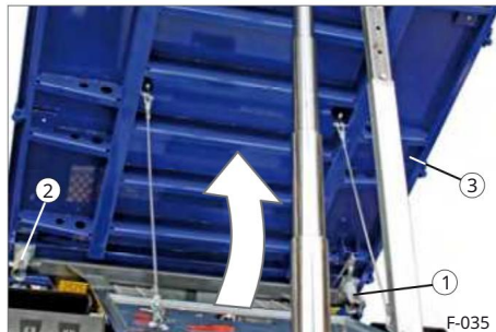
Sl. 58 Naginjanje utovarnog prostora unatrag
