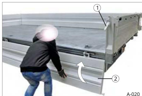
Sl. 22 Preklomite bočnu stijenku
