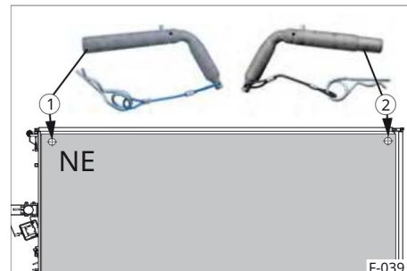
Sl. 62 Utičnica umetnuta s desne strane u smjeru vožnje
