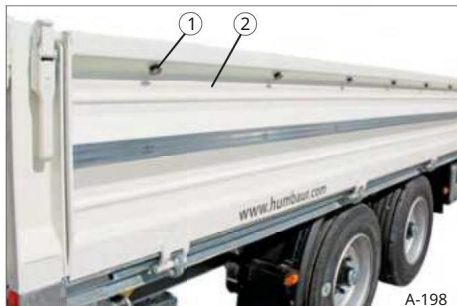
Sl. 210 Pričvršćivanje okruglih gumba
