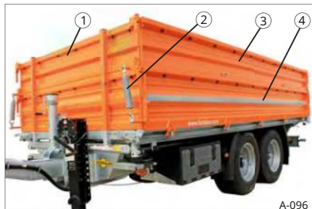
SL 99 Proširenja bočnih zidova od čelika
