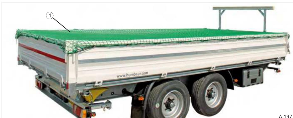
Sl. 209 Prostor za utovar sa zategnutom mrežom za pokrivanje 1
