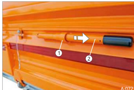
Sl. 94 Uklanjanje upravljačke poluge
