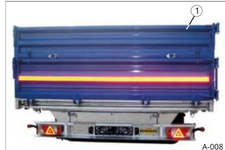
Sl. 10 Pribor za montažu 1 bočni zidni dodatak
