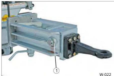
Sl. 21 Podmazivanje okretnih remenica 1 okretna os
