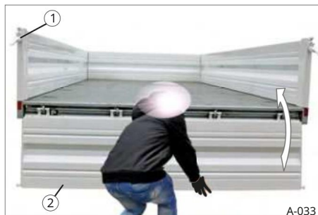
Sl. 41 Preklapite stražnju bočnu ploču prema gore
