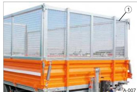
Sl. 9 Pribor za montažu 1 nastavak od čelične mreže
