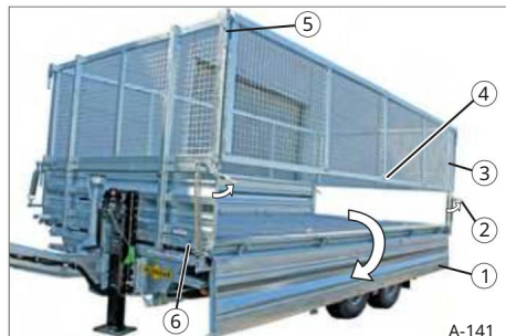
Sl. 147 Bočna stijenka baze preklopljena u stranu, pričvršćivanje čelične rešetke se zamahuje
