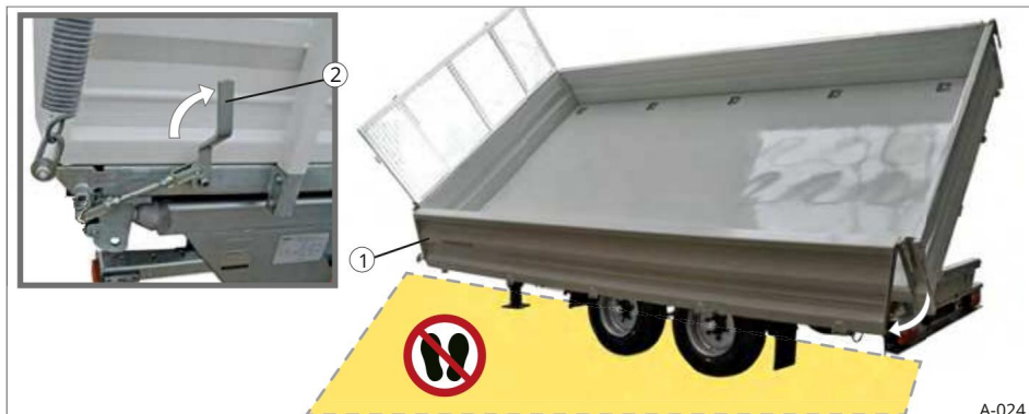
Sl. 26 Bočna stijenka u radu s njihalom
