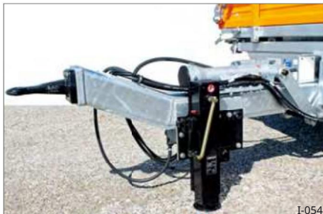
Sl. 28 okretni potporni uređaj za opciju utovara kroz
