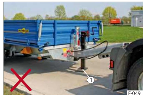
Sl. 69 Vožnja sa spuštenom potpornom nogom
