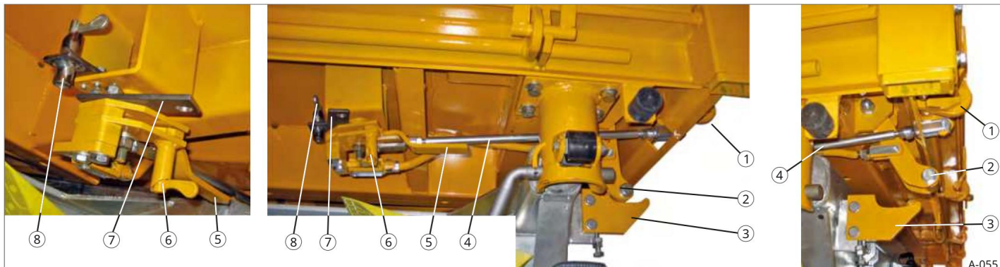
Sl. 51 Središnje zaključavanje s poluautomatskim otključavanjem za rad njihala
