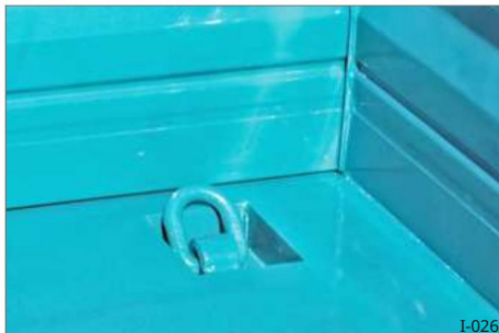
Sl. 34 Prsten za pričvršćivanje, uvlačiv u džep
