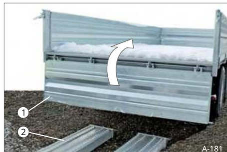
Sl. 192 Zatvaranje stražnje bočne stijenke
