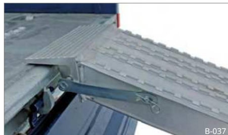
Sl. 8 Utovarne rampe sa sigurnosnim kukama
