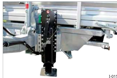
Sl. 26 Potporni uređaj na prednjoj strani
