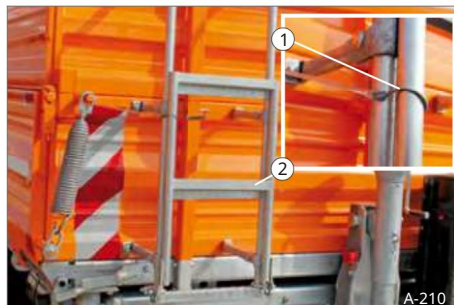
Sl. 224 Osiguravanje pristupnih ljestava
