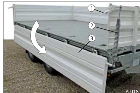
Sl. 20 Bočna stijenska preklapljena prema dolje
