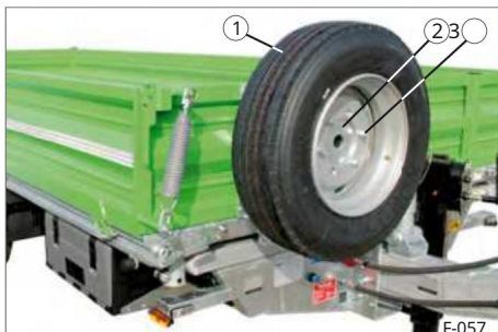
Sl. 82 Rezervni kotač na pregradi
