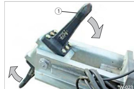
Sl. 23 Uklonite višak masnoće 1 Zug se
