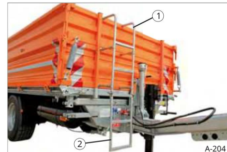
Sl. 221 Rasklopljene pristupne ljestve
