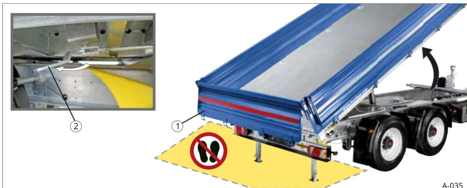
Sl. 43 Stražnja bočna stranica u radu s njihalom
