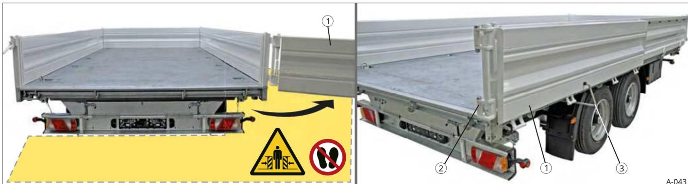
Abb. 61 Heck-Bordwand kao Drehflügel
