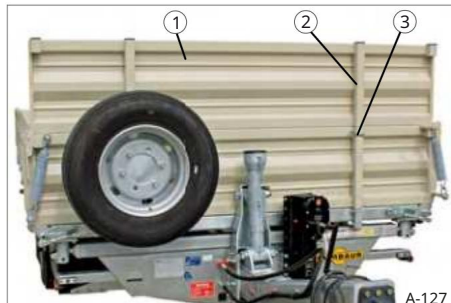
Sl. 133 Pričvršćivanje prednjeg bočnog zida
