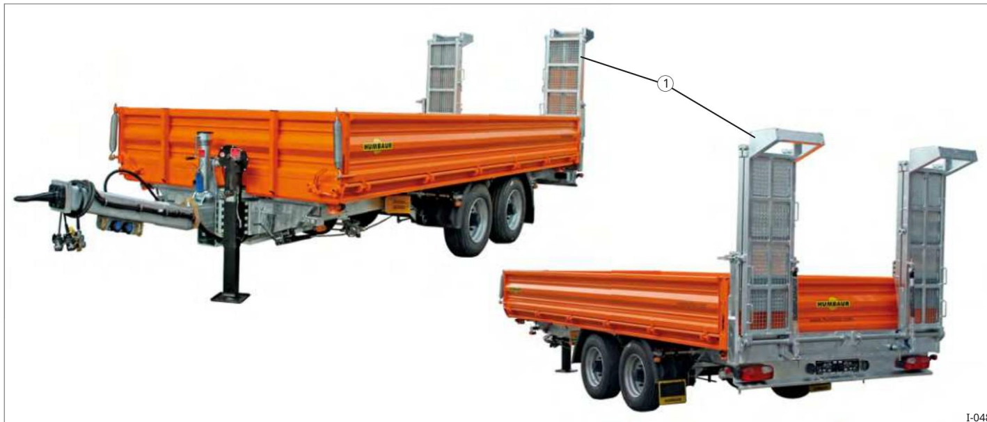
Sl. 8 HTK s fiksnim pristupnim rampama 1
