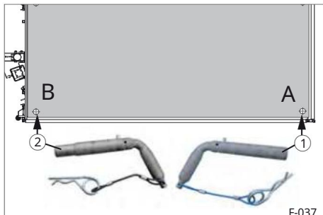
Sl. 60 Utičnica umetnuta s lijeve strane u smjeru vožnje
