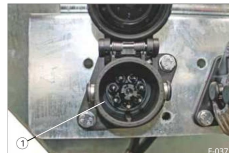
Sl. 16 EBS/ABS utičnica dolje lijevo
