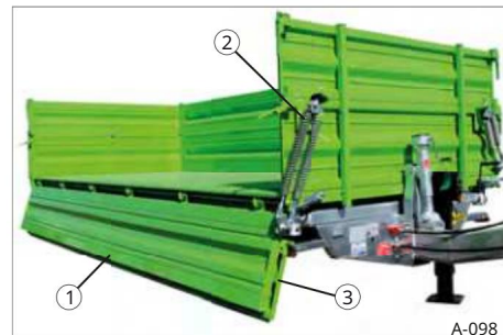
SL 100 Proširenja bočnih zidova od čelika
