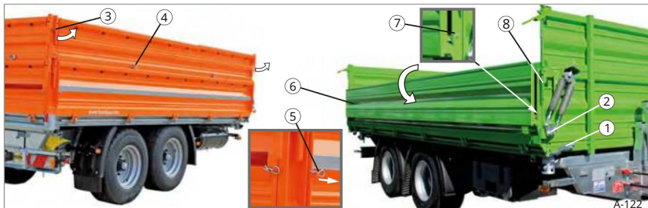
Sl. 128 Produžetak bočnog zida preklopljen u stranu
