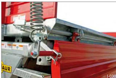
Sl. 41 Zaključavanje bočnih stijenki
