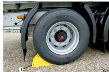
Sl. 88 Klinovi za kotače postavljeni ispod
