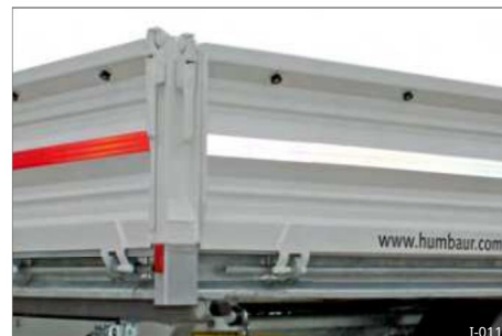
Sl. 15 Okrugli gumbi na bočnim stijenkama
