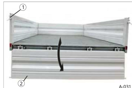
Sl. 39 Stražnja bočna stijenka sklopljena prema dolje
