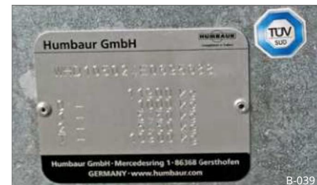
Sl. 18 Tipska pločica / podaci o težini
