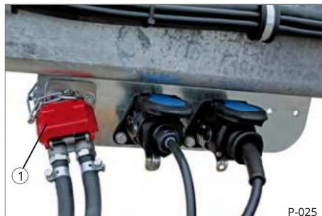
Sl. 5 Duo-Matic sustav brze spojke
