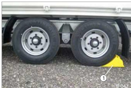
Sl. 48 Postavljeni klinovi za kotače
