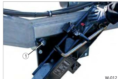
Sl. 12 Podmazivanje okretnog nosača
