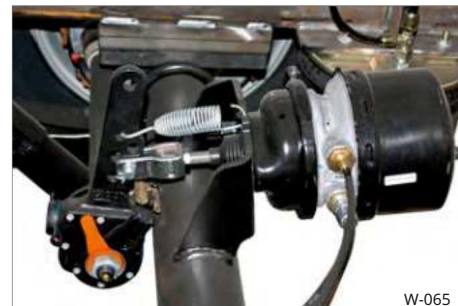
Sl. 65 Otpustite napetost opruge
