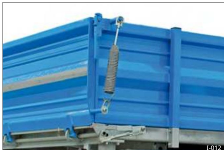
Sl. 11 Zatezne opruge za bočne stijenke
