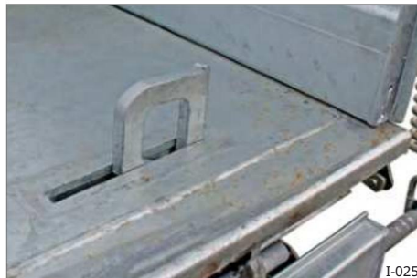
Sl. 37 Prstenovi za pričvršćivanje mača, uvlačivi
