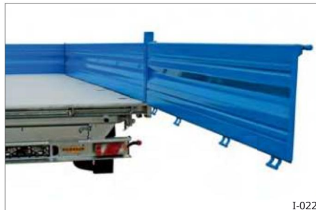
Sl. 36 Stražnja bočna stijenka kao krilna vrata
