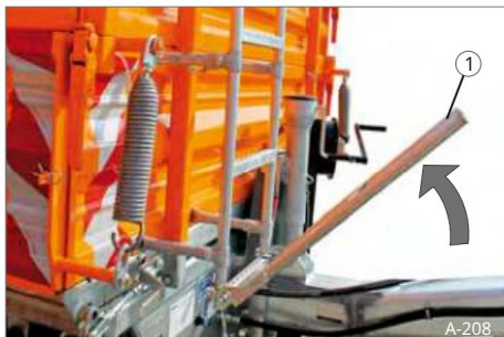
Sl. 222 Preklopite pristupne ljestve 1 sklopivi dio ljestava
