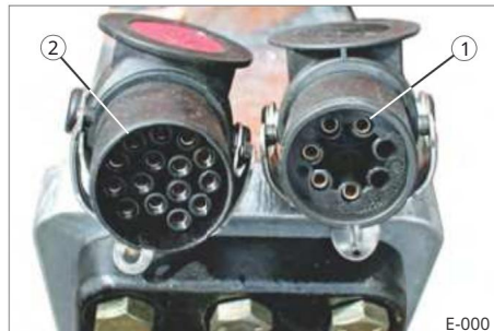
Sl. 2 Utični spojevi, standardni 24 V 1 7-pinski EBS/ABS konektor (ISO 7638) 2 15-pinska električna konektora (ISO 12098)
