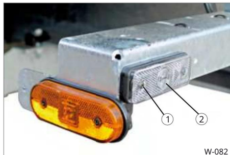
Sl. 80 Prednje svjetlo za označavanje
