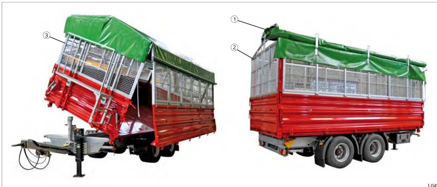
Sl. 9 HTK s čeličnom rešetkastom konstrukcijom i rolo ceradom
