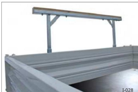
Sl. 17 Nosač na prednjoj bočnoj stijenci, npr. za žlicu utovarivača na kotačima / bagera
