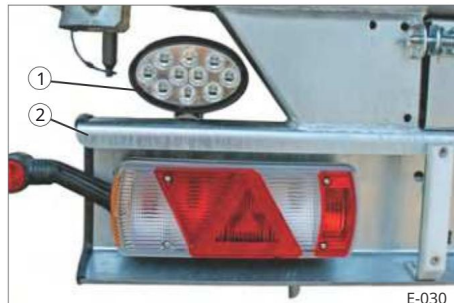
Sl. 25 Radno svjetlo straga; desno i lijevo osvjetljenje
