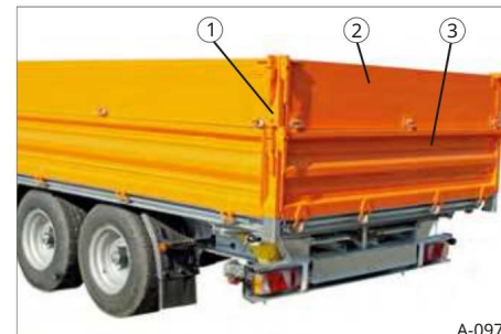
Sl. 103 Produžeci bočnih zidova izrađeni od aluminija
