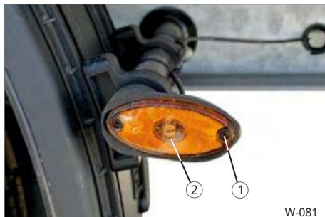
Sl. 79 Bočno svjetlo "LED"
