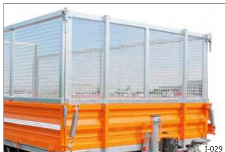
Sl. 19 postavljen na bočne zidove baze
