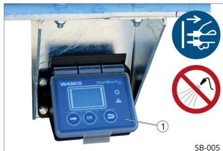
Rys. 8 Urządzenie SmartBoard zamknięte 1 osłona ochronna
