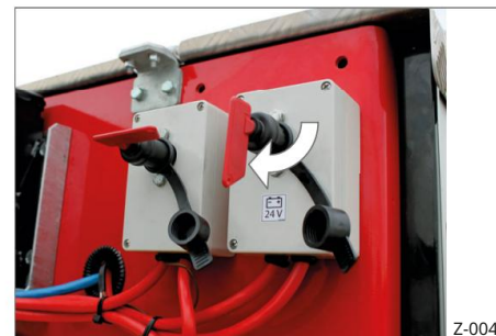
Sl. 8 Uključivanje baterija (ON)
