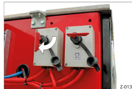
Sl. 19 Uključite napajanje (UKLJ.)
