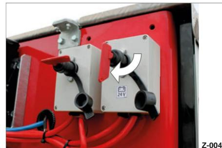
**Fig. 8** Accensione delle batterie (ON)
