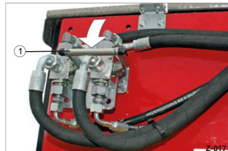
**Fig. 23** Alimentazione idraulica "Elettropompa"
