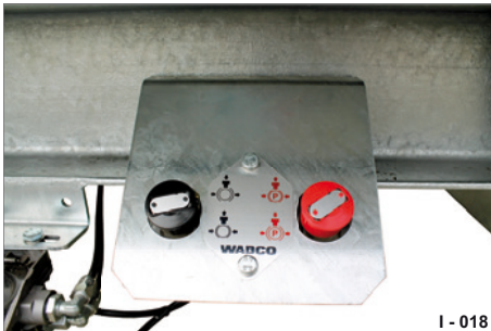
Abb. 18 Druckluft-Feststellbremse mit Feder-speicherzylinder
