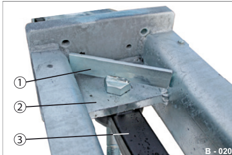
Abb. 19 Zugöse D50 unten angeschlagen
