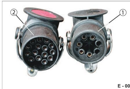
Abb. 7 Steckverbindungen, Standard 24 V 1 7-poliger EBS/ABS-Stecker (ISO 7638) 2 15-poliger Elektrik-Stecker (ISO 12098)
