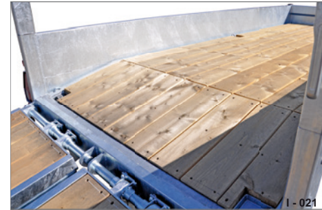
Abb. 21 Holzbohlen (Fichtenholz 40 mm)
