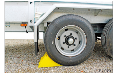
Abb. 55 Beispiel: Unterlegkeile untergelegt
