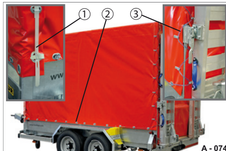
Abb. 78 Planenteil schließen / sichern
