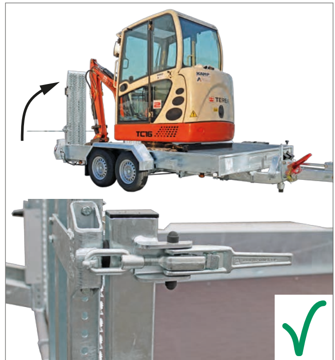
Auffahrrampe geschlossen & gesichert
