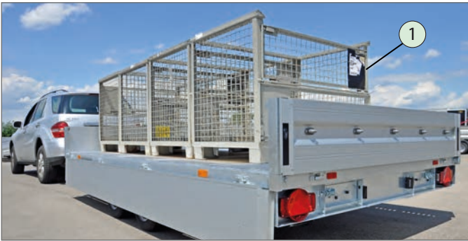
Beispiel „Formschlüssige Ladungssicherung“
