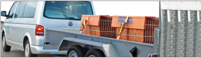
Beispiel „Kraftschlüssige Ladungssicherung“
