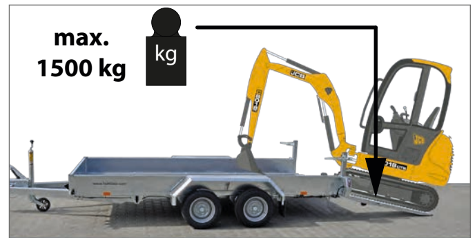
Max. Belastung der Auffahrrampen
